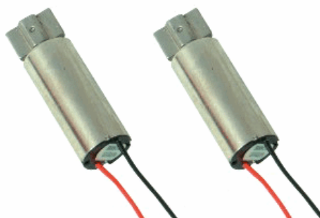
Figura 4.5.1 – Motores Vibratórios Utilizados para Alertar o Deficiente Visual (Fonte: PRECISION MICRODRIVES, 2005)
