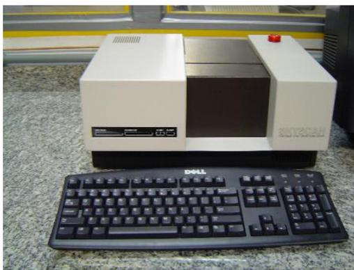
**Figura 3.4.** Equipamento de microtomografia computadorizada usado para obter as imagens tomográficas.
