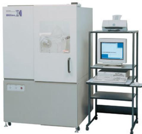
**Figura 3.3.** Difratorômetro de raios-X (Fabricante:Shimadzu, Modelo:XRD 7000).
