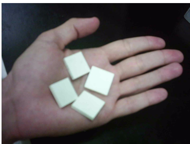
Figura 17: Pastilhas de Alumina usadas para análise com espessura de 4mm.
