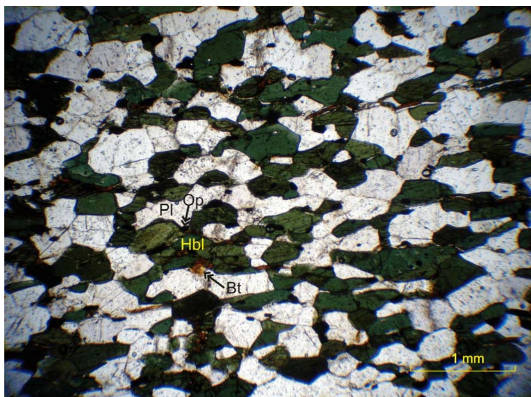
Figura 59: Fotomicrografia do anfibolito do Domínio Itálva. Textura nematoblástica com a paragênese hbl+pl+op. Amostra IV-VIII-10.
