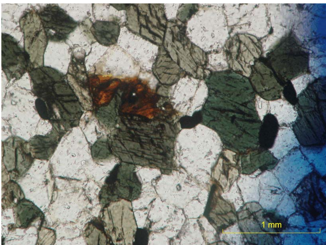
Figura 61: Fotomicrografia do anfibolito do Domínio Itálva mostrando o crescimento tardio de biotita ao redor dos grãos de hornblenda. Amostra IV-VII-10.
