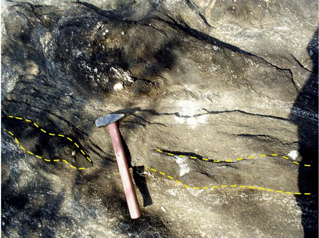
Figura 17: Enclave de rocha metabásica no paragnaisse da Unidade Cambuci. Estes enclaves seguem um padrão alinhado como mostrado pela linha pontilhada amarela. JI-RM-13.
