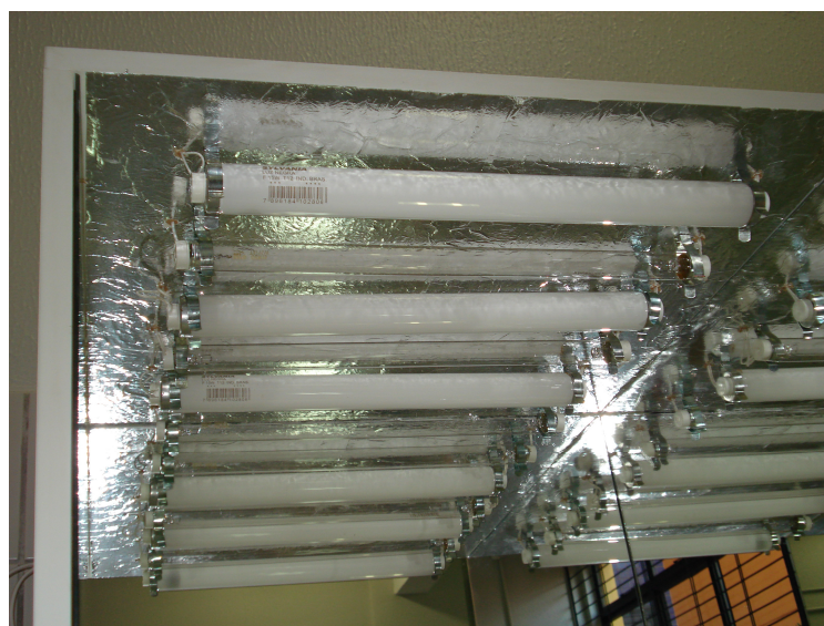
Figura 18 – Disposição das lâmpadas na Câmara de UV montada no laboratório do Centro Universitário Franciscano ( UNIFRA ).
