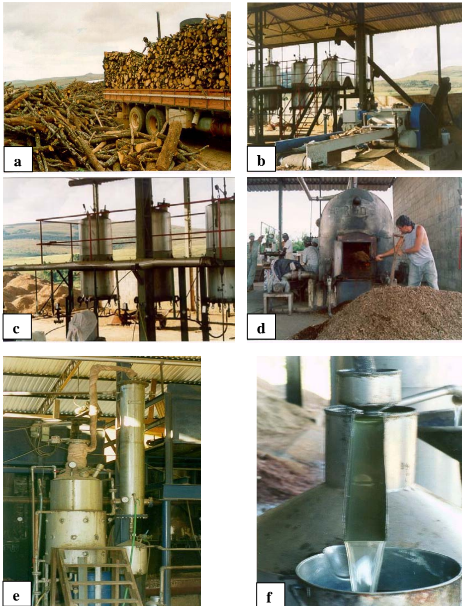
FIGURA 5.3 Fases do processo industrial de extração do óleo de candeia: a) caminhão com candeia no pátio da indústria; b) picador que transforma a madeira em cavacos; c) altoclaves (dornas) onde os cavacos são colocados; d) caldeira que gera o vapor d'água
