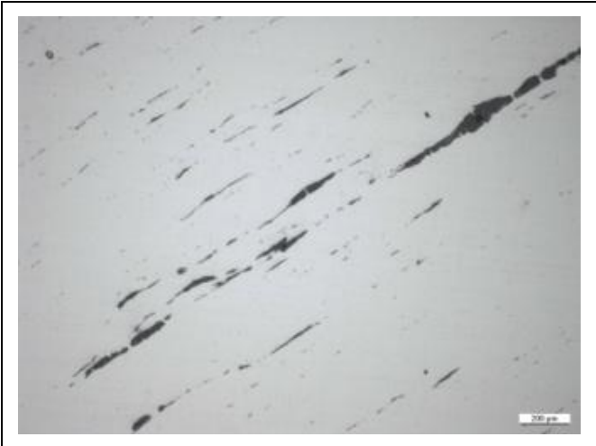
Figura n. 45 – Sem ataque. Inclusões, alongadas e rompidas durante o trabalho mecânico para conformação.
