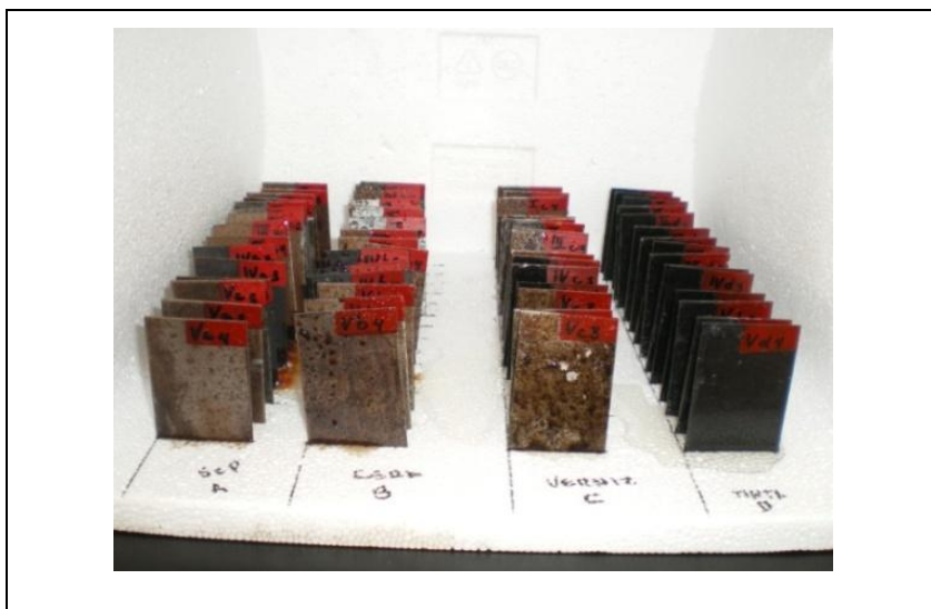
Figura n. 77 – Corpos de prova posicionados na caixa para envelhecimento.
