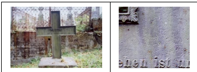
Figura n. 32 – Ornamento “cruz/lápide” do túmulo T048 e detalhe mostrando os primeiros sinais de corrosão na sua superfície do artefato, quatro anos após a restauração, quando foi utilizado o ácido fosfórico. (Fotografia CARRASCO, 2004)
