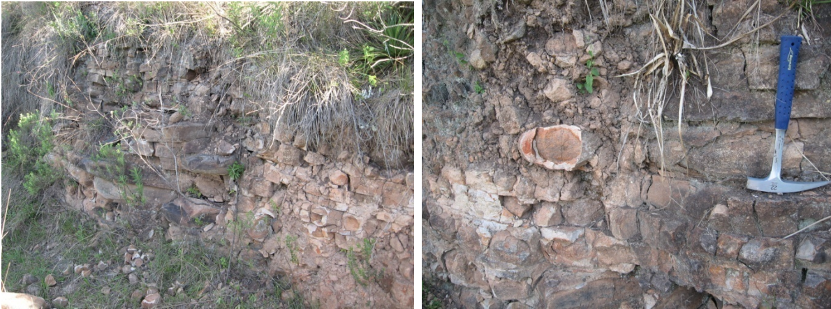
Figura 13 – Afloramento do ponto 12, detalhe para o forte fraturamento sub-horizontal, e para decomposição esferoidal da rocha.
