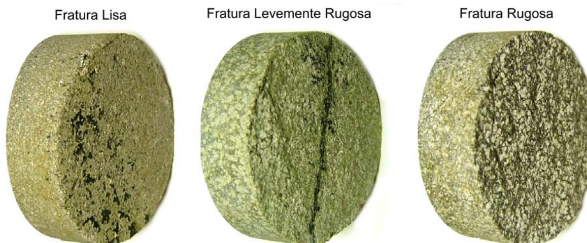
Figura 23 – Exemplos de rugosidade encontrados nas fraturas das sondagens.
