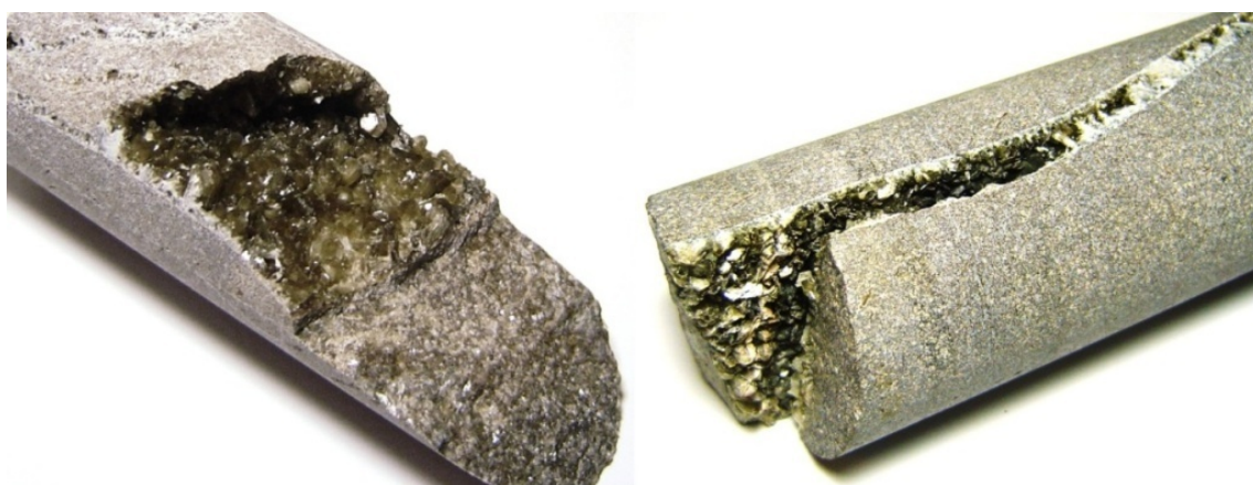
Figura 21 – Amostra de dacito com fratura aberta preenchida por veio de zeólita.
