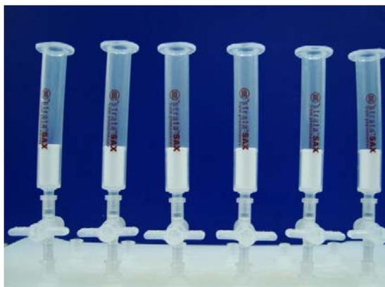
Figura 3.4: Cartucho utilizados na extração do ATTM.
