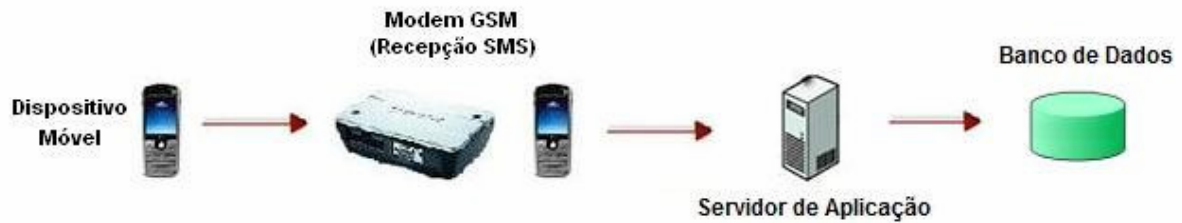
Figura 22: Processo de recepção e encaminhamento das mensagens SMS
