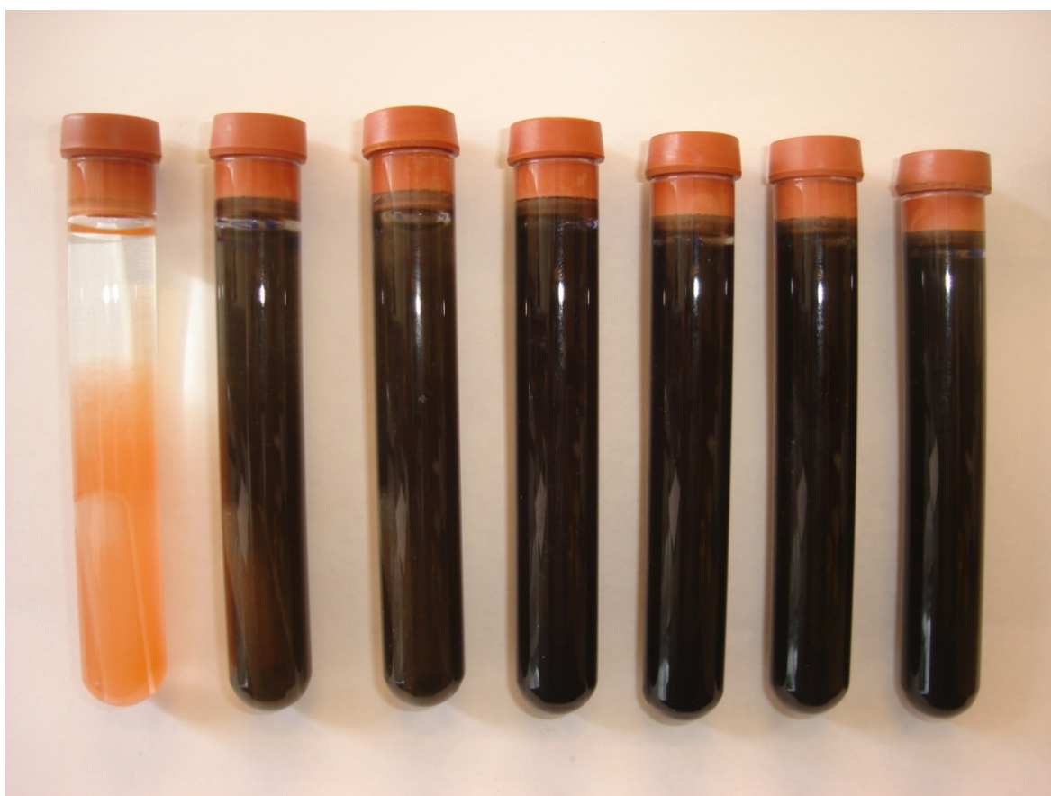
Figura 4.2: Isolados de BRS das amostras R1A e R3A apresentando rendimento diferenciado na redução de sulfato em meio Postgate C após uma semana de incubação à 32 °C em anaerobiose, o primeiro tubo (da esquerda para a direita) demonstra um controle negativo.
