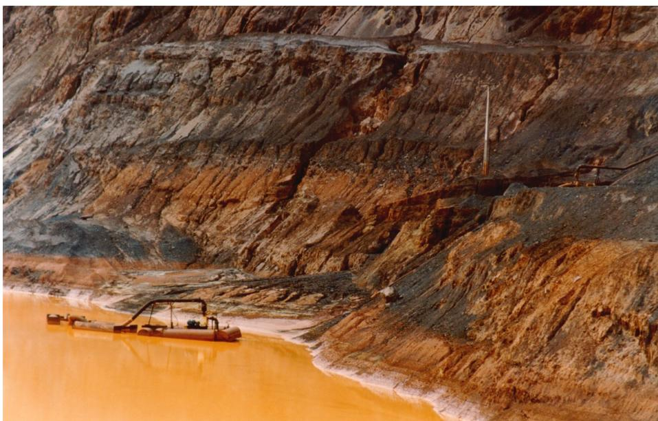
**Figura 2.4:** Bombeamento da água acumulada no fundo da Cava.
