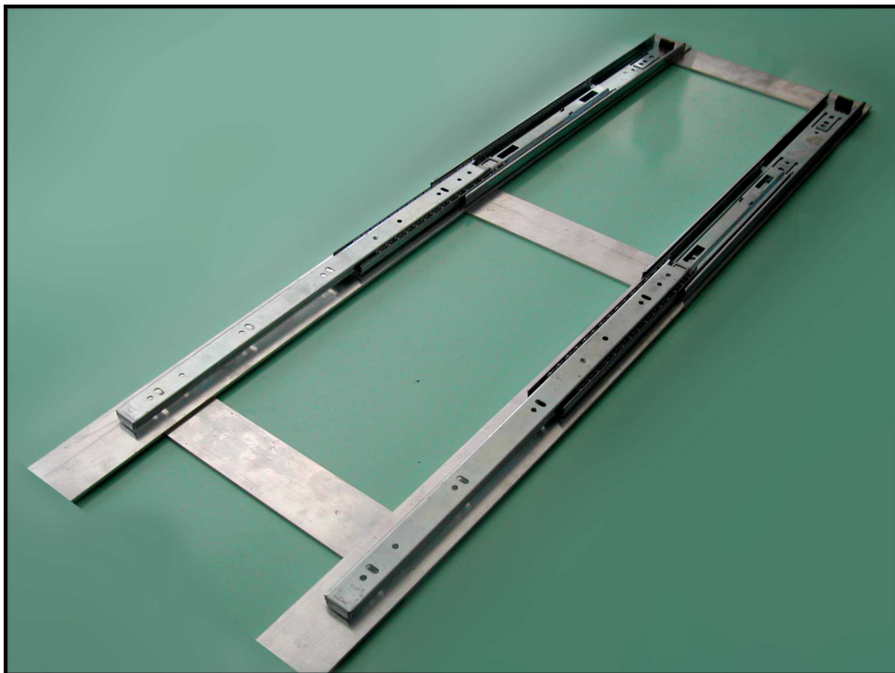
Figura 25 – Montagem da estrutura – Chapas e corredeiras
