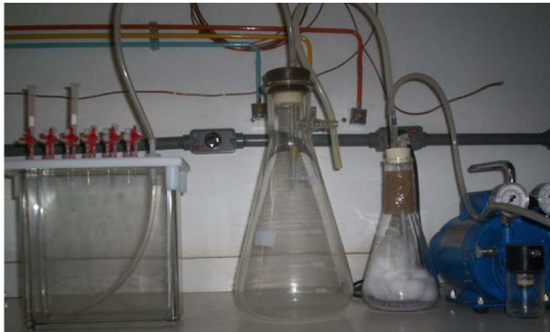
Figura 3.5 - Montagem utilizada no processo de extração em fase sólida dos micropoluentes das amostras de esgoto.
