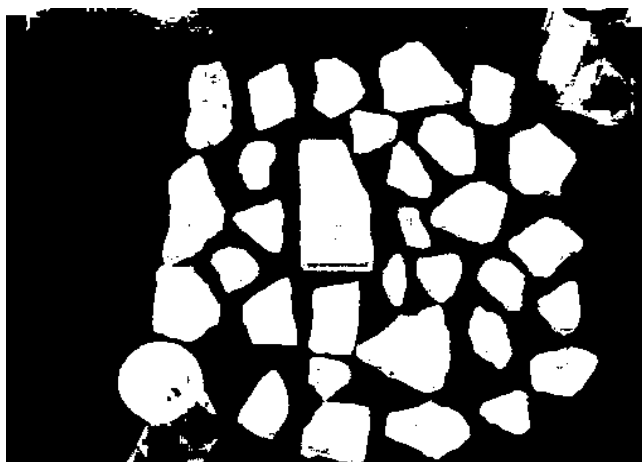
Figura 5.13: Imagem resultante do processo de limiarização
