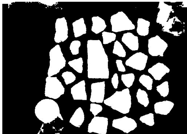
Figura 5.14: Imagem resultante da aplicação da IFT CloseHoles
