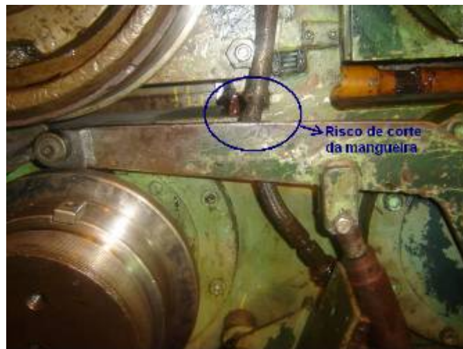
Figura 29 – Mangueira do push-up roll cortada devido ao impacto da chapa de aço.
