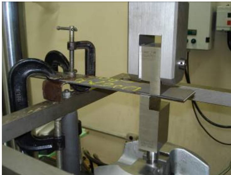
Figura 27 – Foto com a amostra de aço IF posicionada na MTS 810.23M entre as ferramentas de corte.
