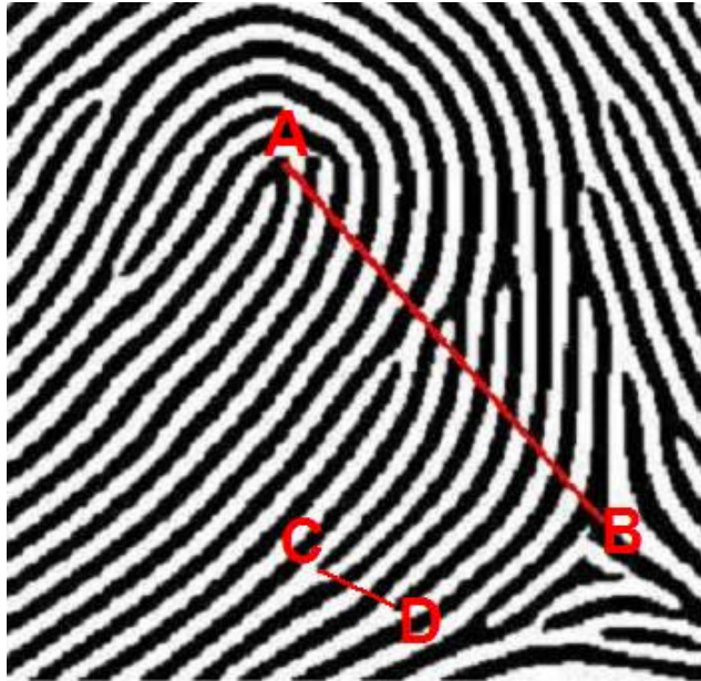
Figura 4.3 Exemplo do cálculo do número de linhas entre o núcleo e o delta (11 linhas) e entre as minúcias C e D (2 linhas)
