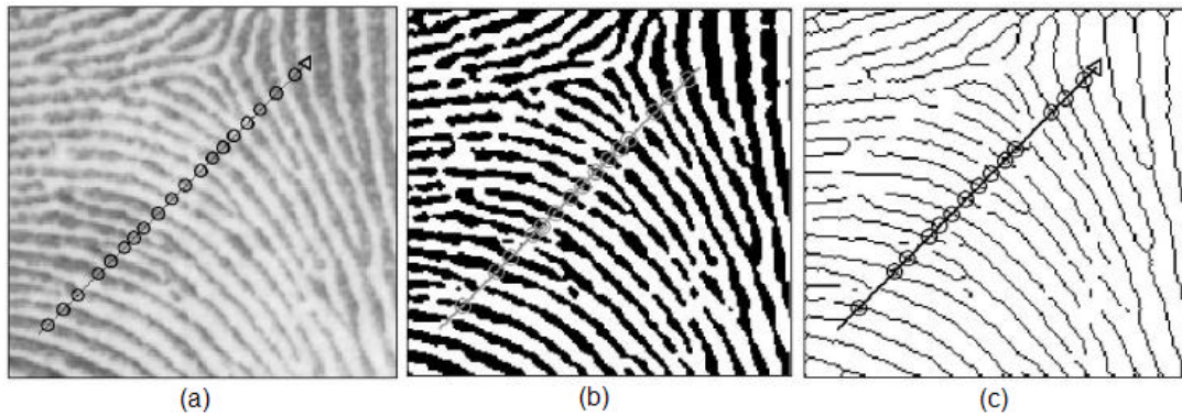
Figura 4.4 (a) Imagem em escala de cinza, (b) binarizada e (c) binarizada e afinada
