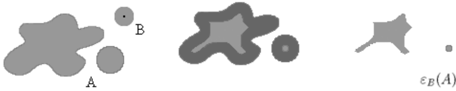
Figura 1.12: Erosão do conjunto A pelo EE B .
