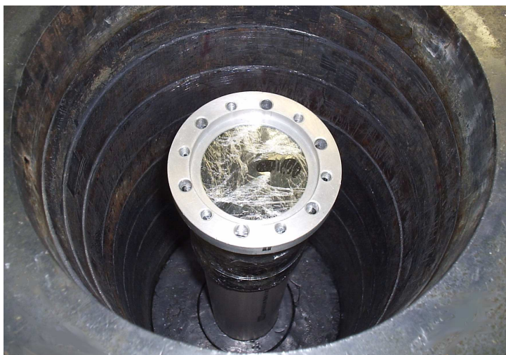
Figura 3.8: Foto da blindagem de chumbo com o detector NaI(Tl) em seu interior.
