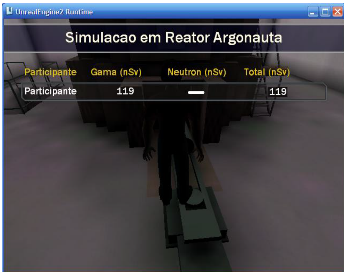
Figura 6.27 – Janela de visualização(HUD), no Unreal, com a dose gama recebida acumulada ao longo do espaço e tempo.
