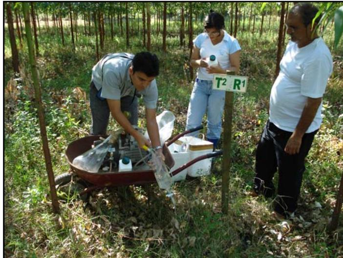
**Figura 4.21 - Coleta do percolado armazenado no coletor de drenagem livre**
