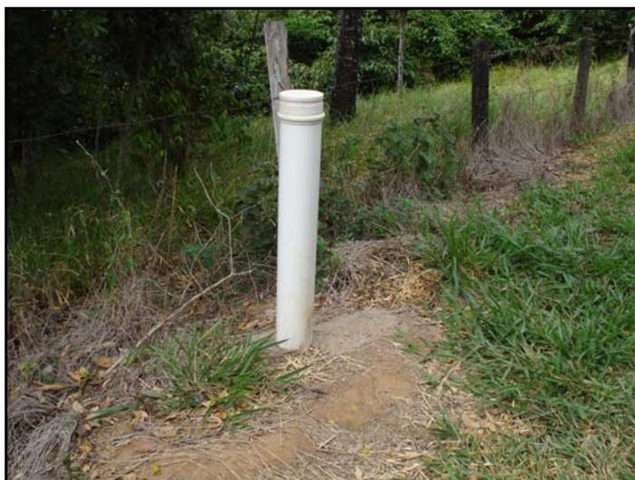
**Figura 4.9 - Poço de monitoramento de água subterrânea instalado no experimento**
