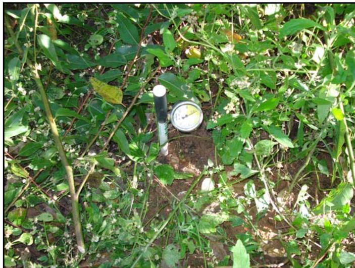
**Figura 4.17 - Tensiômetro instalado na área experimental**
