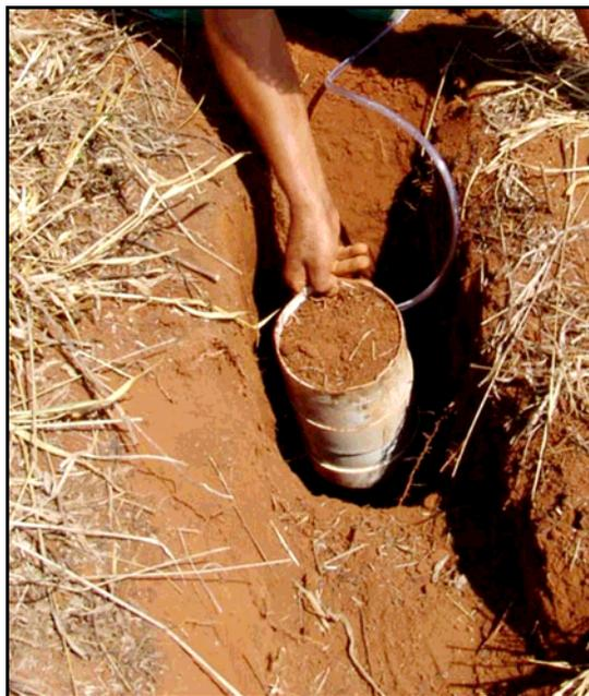
**Figura 4.13 - Instalação de um coletor no experimento. Colégio Agrícola, Franca/SP**
