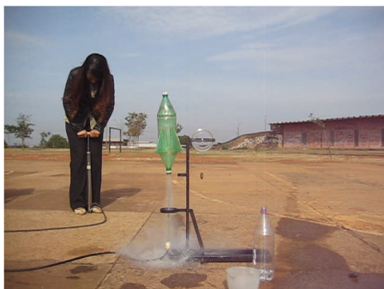
Figura 39 – Lançamento ( 90^\circ e 100 ml de água).
