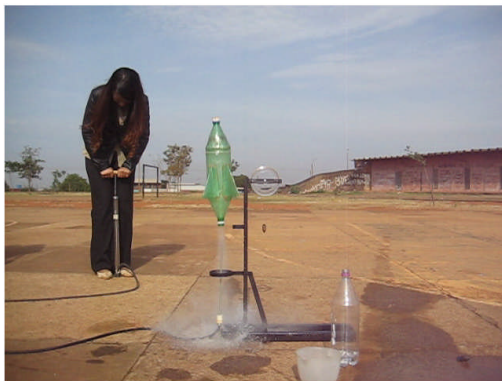
Figura 20 – Lançamento vertical ( 90^\circ e 100 ml de água).
