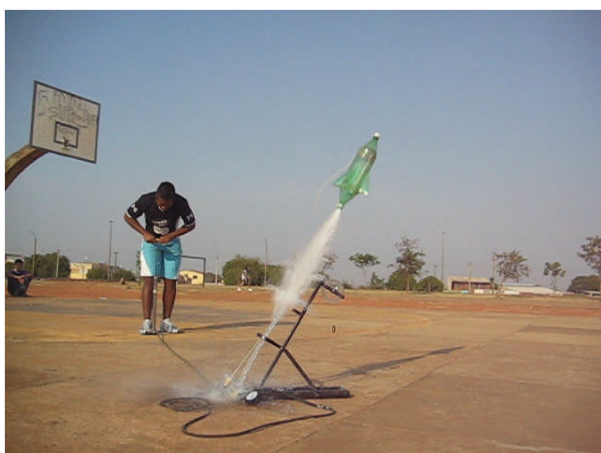
Figura 131 – Lançamento vertical (45 ° e 200 ml).
