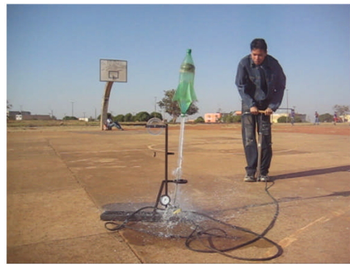
Figura 21 – Lançamento vertical ( 90^\circ e 400 ml de água).
