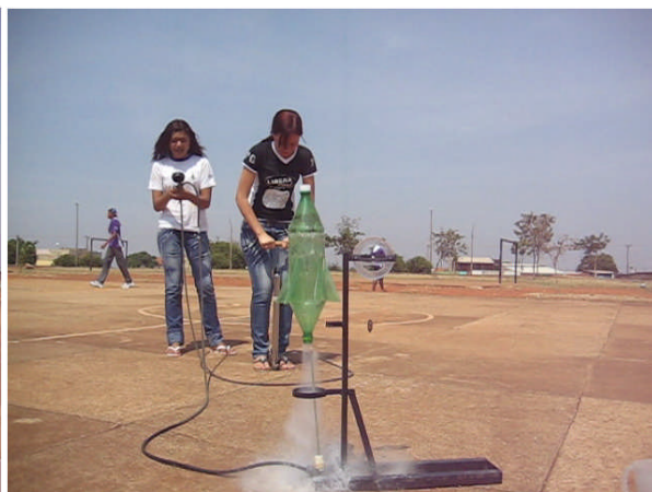
Figura 128 – Lançamento vertical (90 ° e 100 ml).
