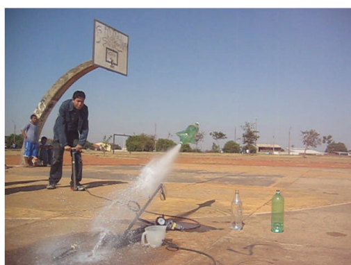
Figura 25 – Lançamento oblíquo ( 30^\circ e 400 ml de água).
