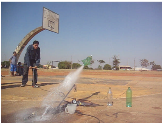
Figura 44 – Lançamento ( 30^\circ e 400 ml de água).
