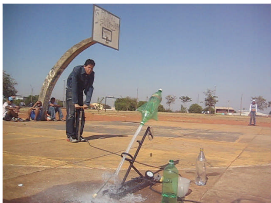
Figura 43 – Lançamento ( 45^\circ e 400 ml de água).
