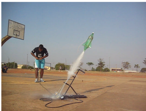
Figura 22 – Lançamento oblíquo ( 60^\circ e 400 ml de água).
