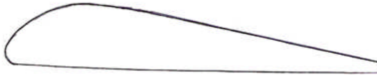
Figura 91 – Modelo do perfil da asa do túnel de vento ( Apêndice K, Figura 121 ).
