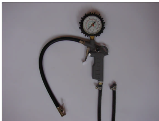
Figura 76 – Manômetro, mangueira e parafuso. Figura 77 – Manômetro e parafuso fixados.
