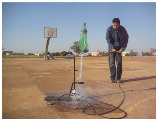
Figura 40 – Lançamento ( 90^\circ e 400 ml de água).
