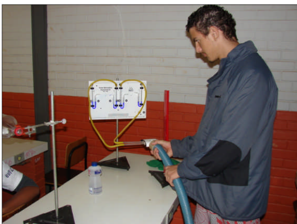
Figura 141 – Pressão nas superfícies do perfil da asa.
