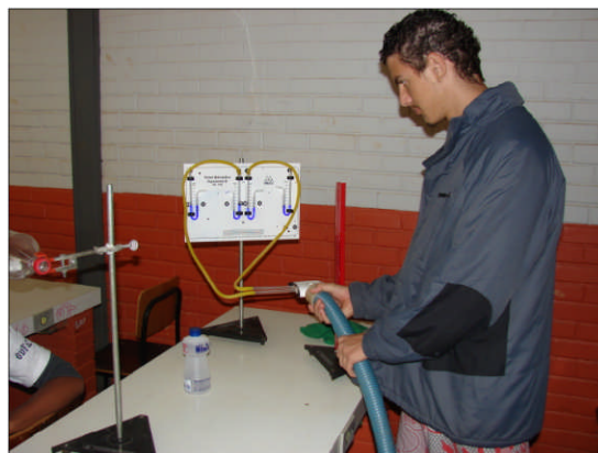
Figura 48 – Pressão aerodinâmica no perfil.
