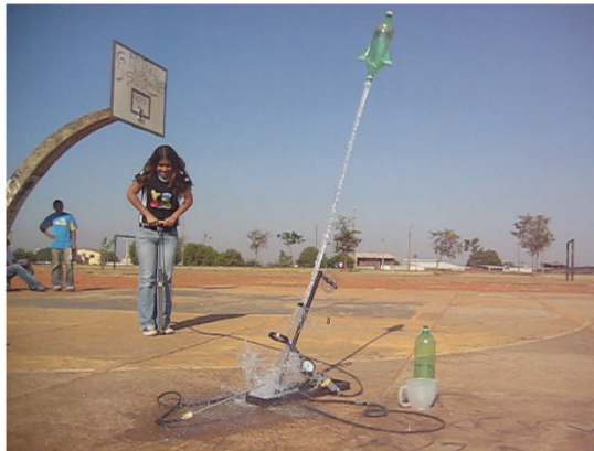
Figura 42 – Lançamento ( 60^\circ e 1000 ml de água).
