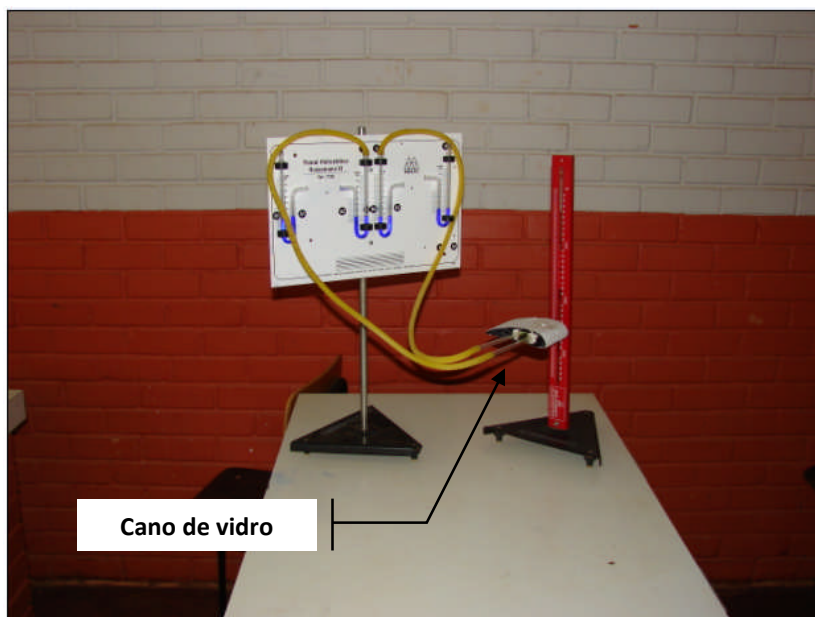
Figura 119 – Perfil da asa interligado ao sensor de pressão.
