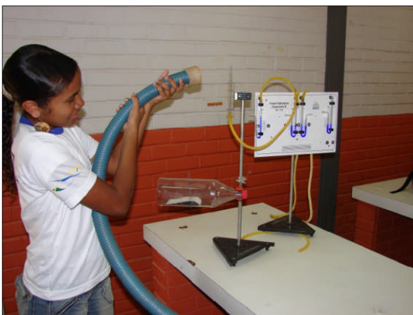
Figura 143 – Sensor de pressão (painel hidrostático).
