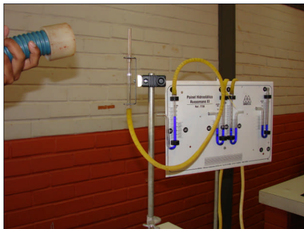
Figura 144 – Verificação da diminuição da pressão.
