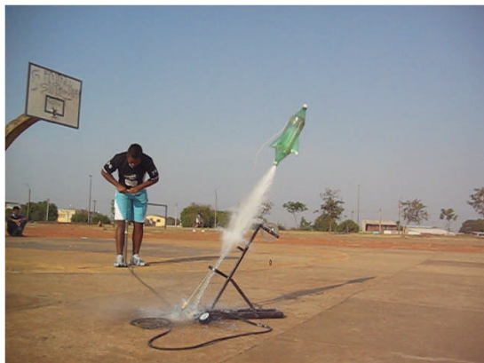
Figura 41 – Lançamento ( 60^\circ e 400 ml de água).
