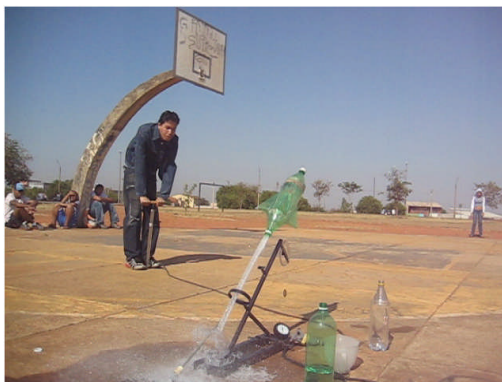
Figura 24 – Lançamento oblíquo ( 45^\circ e 400 ml de água).
