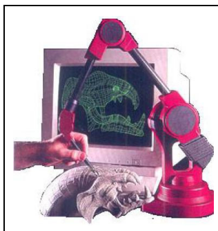
Figura 25 – Digitalizador tridimensional (Fonte: Techno Isel e Maxnc - USA). Oliveira e Rubio (2005).
