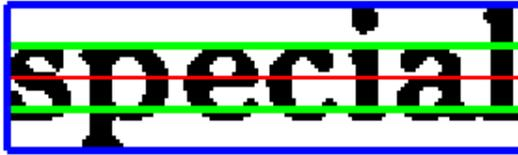
Figura 4.22. Divisão de retângulo envoltório com palavra impressa.
