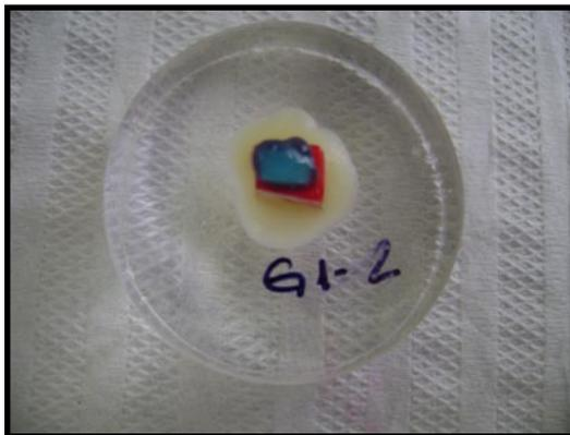
**Figura 4.20:** Ácido fosfórico a 37% aplicado sobre o corpo-de-prova
