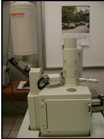
**Figura 4.4:** Microscópio Jeol® - JSM – 6460LV
