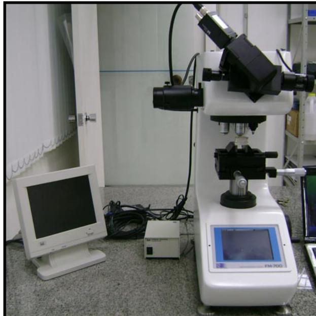
**Figura 4.5:** Microdurômetro - Future Tech-FM-300
