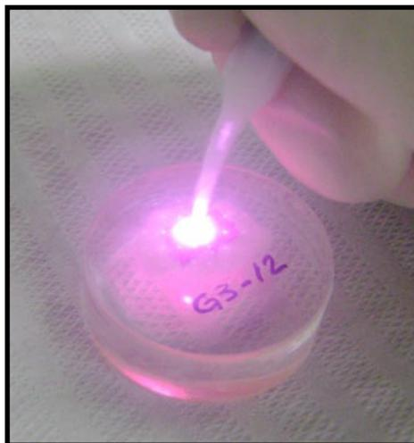
**Figura 4.23:** *Irradiação com laser de Nd:YAG no corpo-de-prova 12 do grupo 3*
