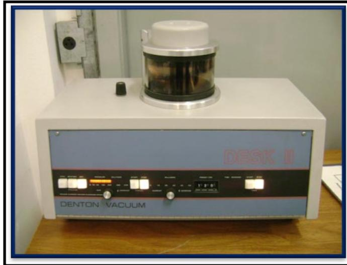
**Figura 4.26:** Aparelho usado para metalização em Ouro – Denton Vacuum®
