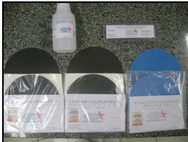
**Figura 4.13:** Lixas de granulação 600 e 1200, pano metalográfico, lubrificante e pasta de diamante de  $1\mu\text{m}$
