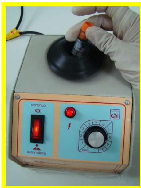
Figura 17. Vórtex usado para homogeneizar os extratos diluídos.
