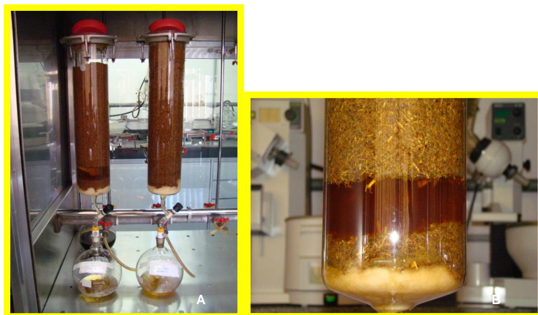
Figura 11. Processo de extração para obtenção dos extratos vegetais por maceração. A, B - percoladores de vidro.
