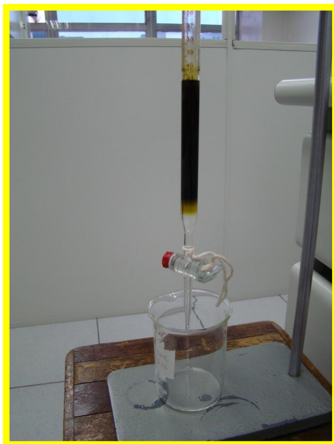
Figura 39. Processo de partição líquido-líquido.
