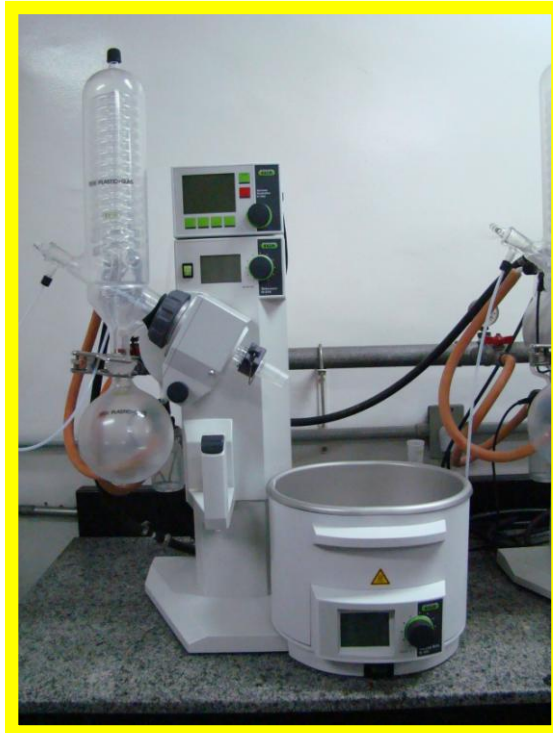
Figura 12. Aparelho rotoevaporador utilizado para remover os solventes orgânicos dos extratos.
