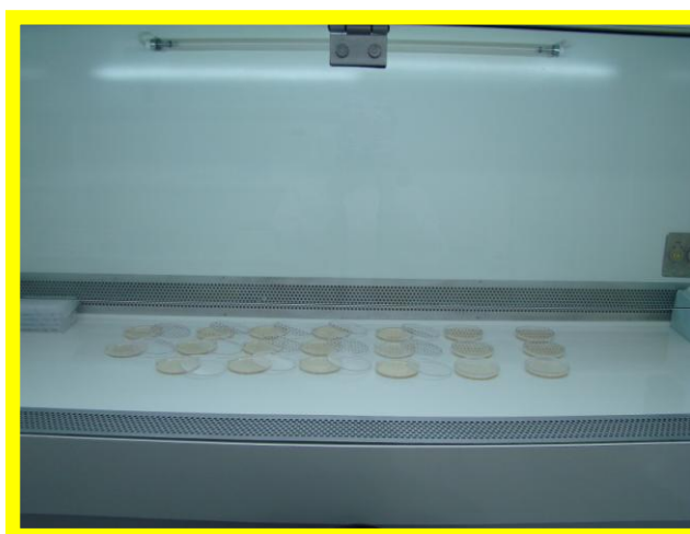
Figura 20. Placas de Petri com meio de cultura Müeller Hinton ágar, no fluxo laminar vertical (Veco®).
