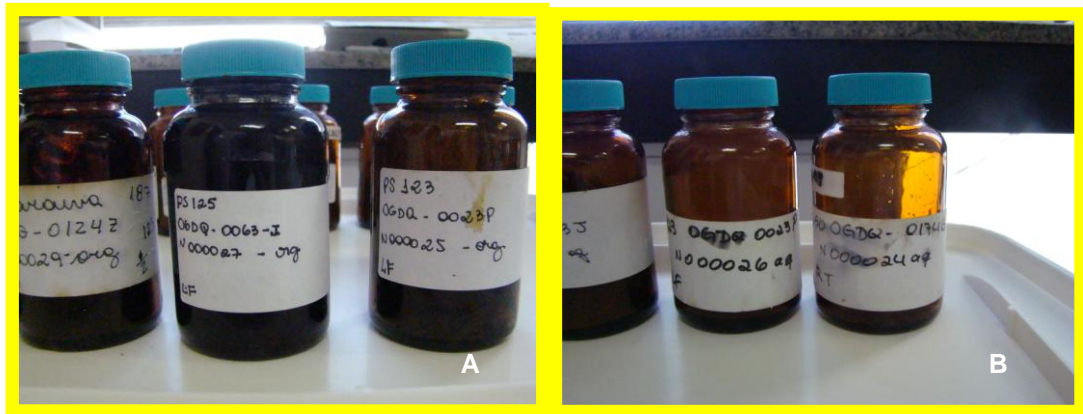
Figura 14. A - orgânico e B – aquoso; extratos acondicionados em frascos de vidro âmbar com tampa de teflon devidamente identificado.
