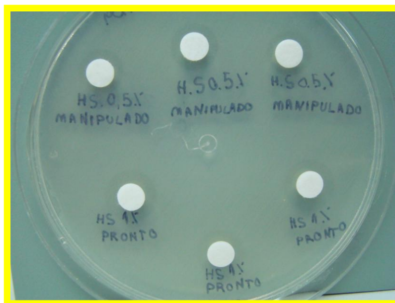
Figura 32. Resultados visualizados no modelo disco difusão em ágar do hipoclorito de sódio (manipulado) 0,5% contra Enterococcus faecalis e hipoclorito de sódio (comercializado) 1% contra Enterococcus faecalis .
