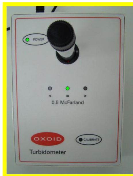
Figura 26. Padronização da suspensão bacteriana utilizando turbidímetro Oxoid®.
