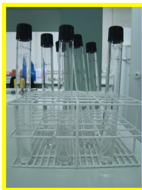
Figura 25. Bateria de tubos de ensaio preparada para a diluição da suspensão bacteriana.
