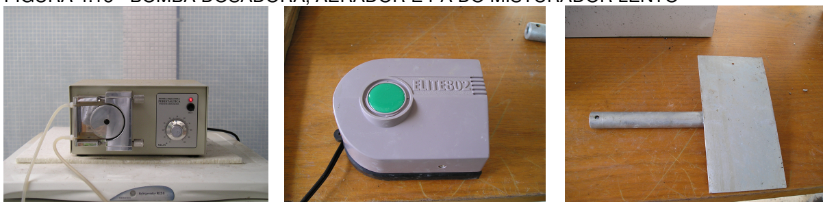
FIGURA 4.18 - BOMBA DOSADORA, AERADOR E PÁ DO MISTURADOR LENTO
