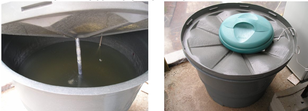
FIGURA 4.12 - FOTOS DO TANQUE DE ARMAZENAMENTO DE ESGOTO SINTÉTICO OPERANDO COM MISTURADOR LENTO
