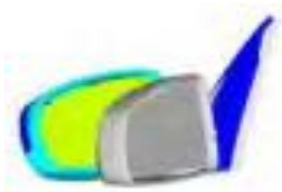
Figura 21: 2ª frequência natural, eixo X
