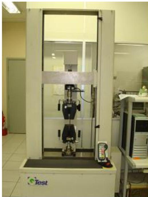
Imagem 04: Máquina universal de ensaios QTEST
