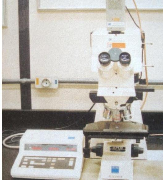
Imagem 06: Microscópio ótico Carl Zeiss, modelo Axiophot
