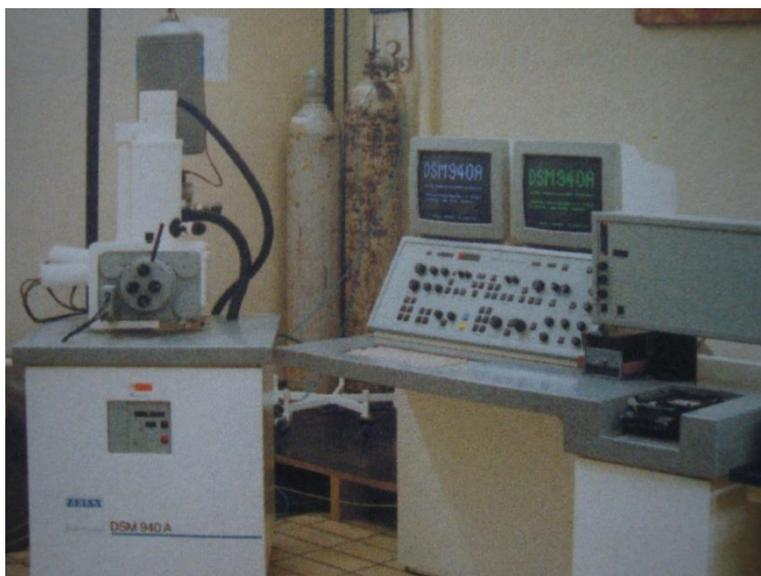
Imagem 07: Microscópio eletrônico de varredura
