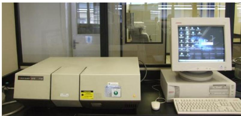
Imagem 03: Aparelho FTIR modelo 16PC da marca Perkin Elmer
