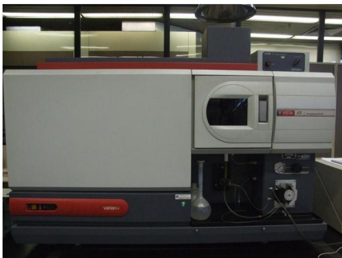
Imagem 02: Equipamento ICP AES modelo VISTA AX
