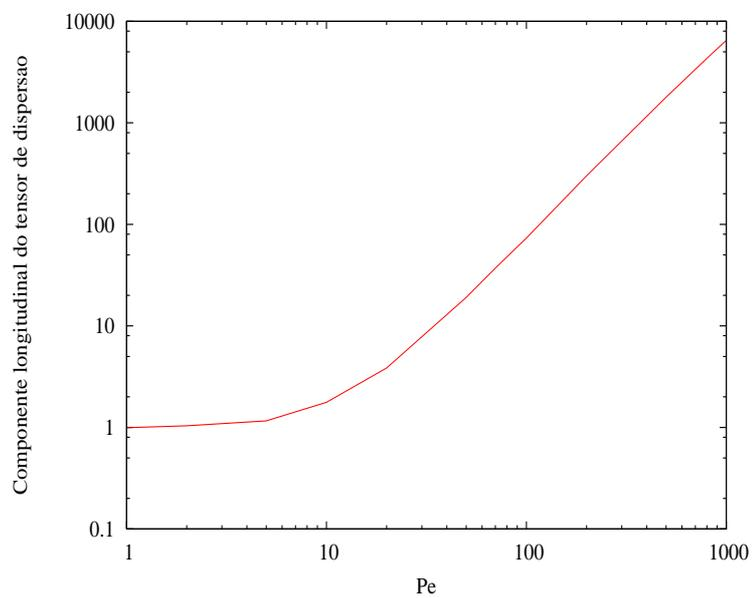
Figura A.7:  $K_{\parallel}$  em função de  $Pe$ , Tubo com Obstáculo.
