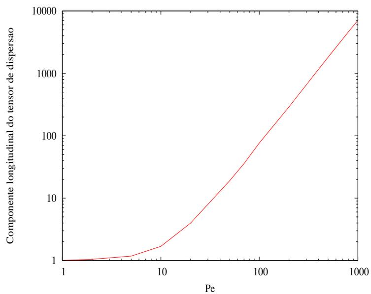
Figura A.3:  $K_{||}$  em função de  $Pe$ , Tubo.
