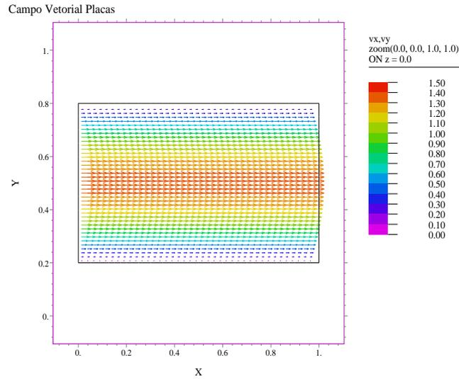
Figura 4.3: Corte XY do campo vetorial do meio extratificado.
