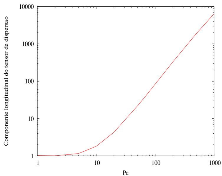
Figura A.15:  $K_{\parallel}$  em função de  $Pe$ , Tubo com Obstáculo e Aberturas.
