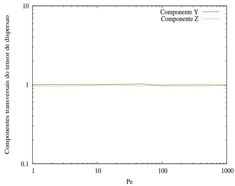
Figura A.4: Componentes transversais Y e Z em função de  $Pe$ , Tubo.
