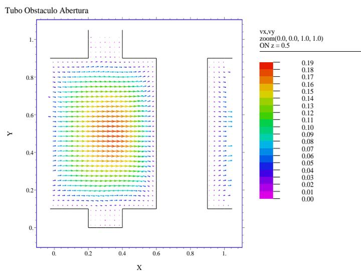
Figura A.9: Escoamento XY, Tubo com Obstáculo e Abertura.
