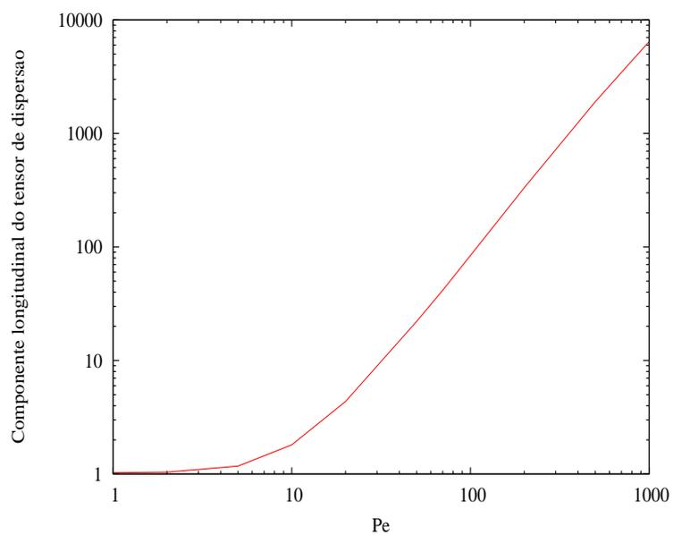
Figura A.11:  $K_{\parallel}$  em função de  $Pe$ , Tubo com Obstáculo e Abertura.
