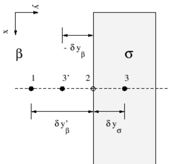
Figura 3.5: Visão bidimensional da trajetória ao cruzar uma interface : (1) Posição inicial, (2) Na interface, (3) Mudança de meio e (3') Choque elástico.
