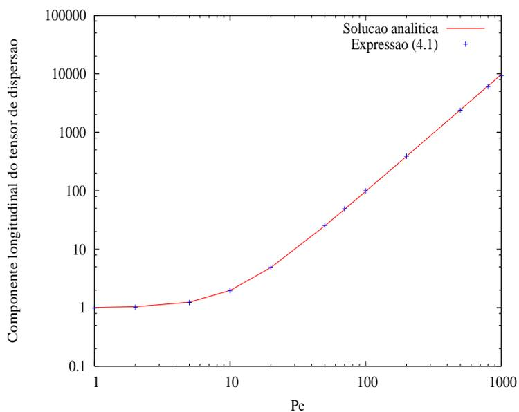
Figura 4.2: Cruzamento entre  $K_{\parallel}$  analítico e  $K_{\parallel}$  pela expressão (4.1) em função de  $Pe$ .
