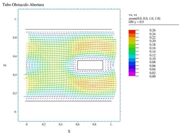
Figura A.10: Escoamento XZ, Tubo com Obstáculo e Abertura.
