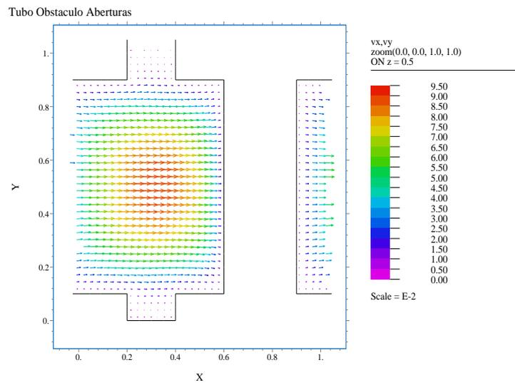
Figura A.13: Escoamento XY, Tubo com Obstáculo e Aberturas.
