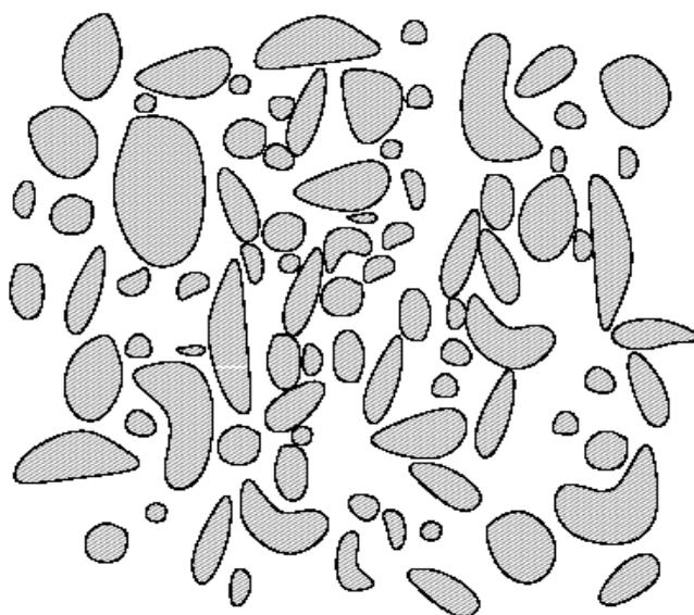
Figura 1.1: Representação esquemática de um meio poroso.
