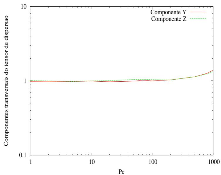
Figura A.16: Componentes transversais Y e Z em função de  $Pe$ , Tubo com Obstáculo e Aberturas.
