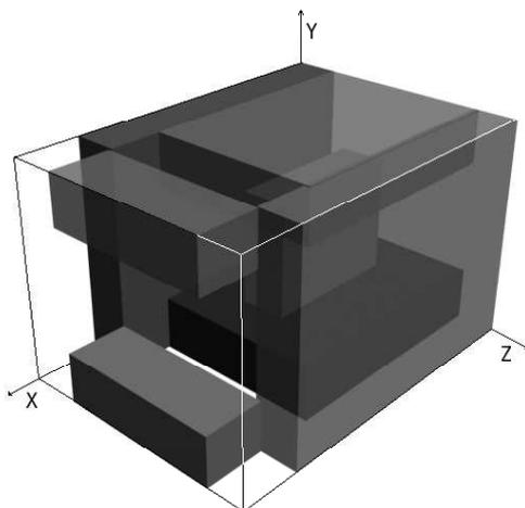
Figura 4.8: Célula tubo com obstáculo e aberturas.
