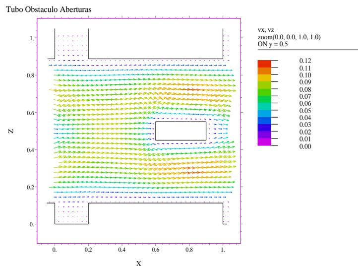
Figura A.14: Escoamento XZ, Tubo com Obstáculo e Aberturas.
