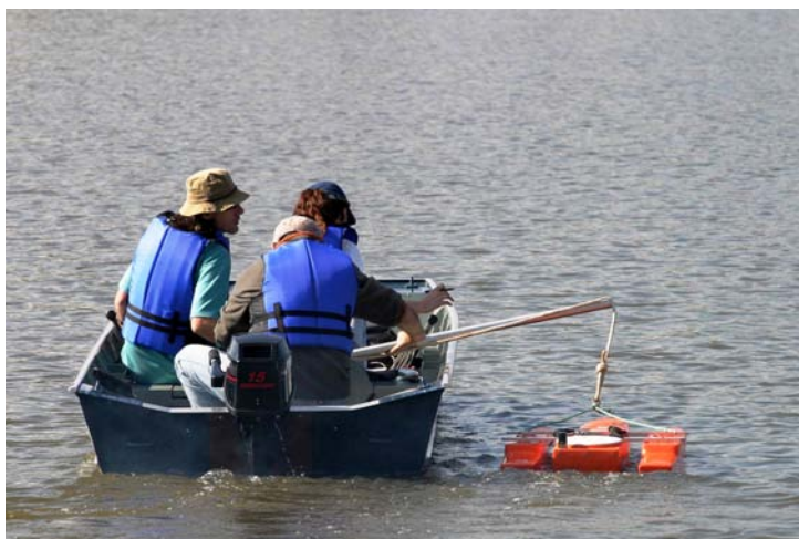
FOTO 13: DE OLHO EM PESQUISAS FUTURAS: BATIMETRIA E MEDIÇÃO DE VELOCIDADES COM SONAR.
