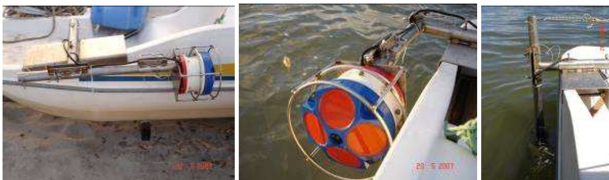
Figura 10 – Levantamento de dados na costa ao sul de Itamaracá, utilizando perfilador ADCP Rio Grande 600 kHz.
