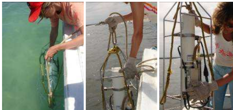
Figura 6 –Levantamento de dados utilizando o perfilador CTD Sea Bird SBE19.
