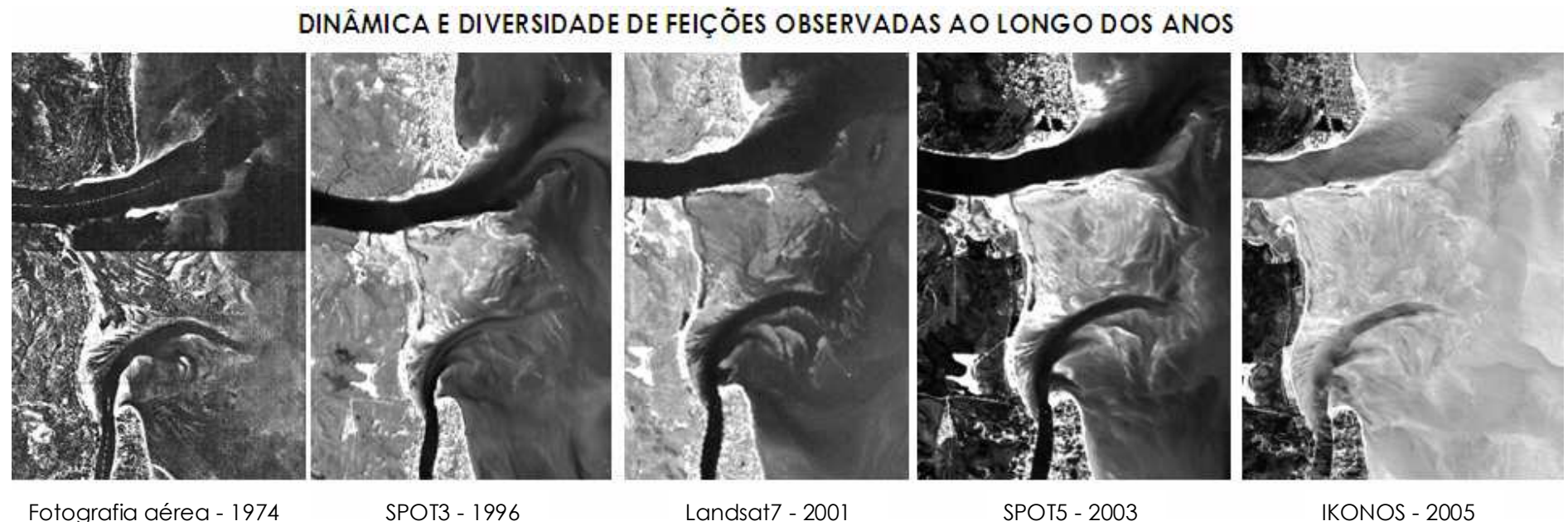
Figura 18 - Intensificação do efeito de molhe hidráulico na desembocadura do braço sul do CSC.
