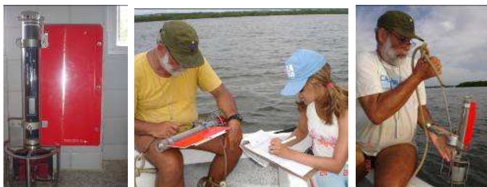
Figura 7 - Levantamento de dados a partir do correntômetro SensorData SD30.
