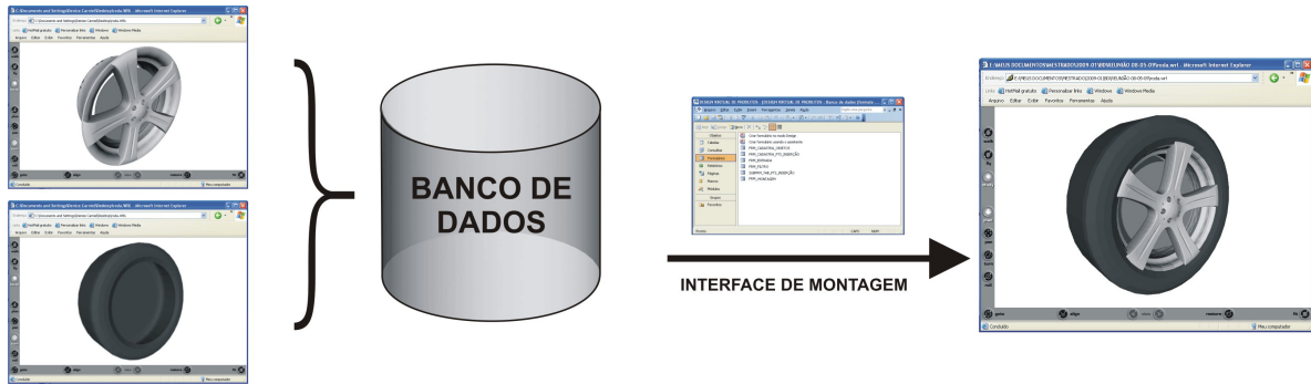
Figura 38: Esquema de funcionamento da metodologia de montagem virtual de produtos.
