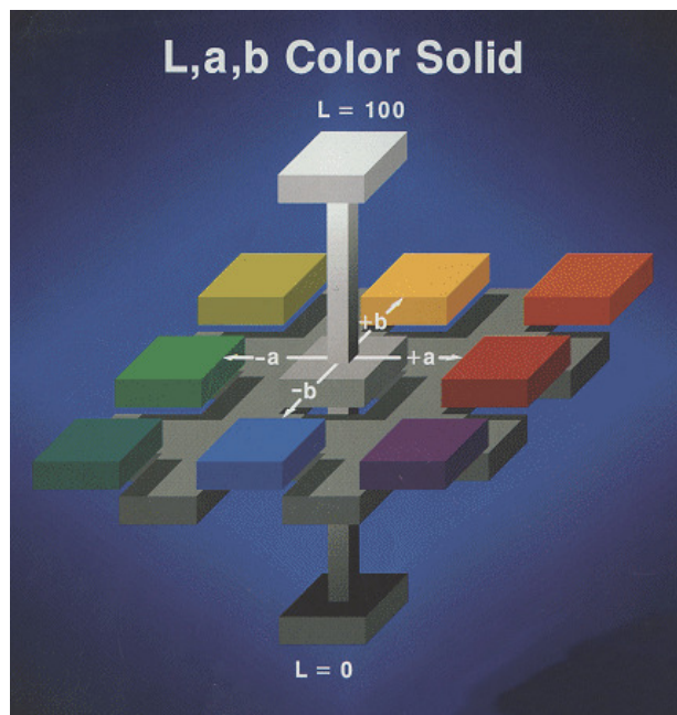
Figura 3.7. Espaço colorimétrico CIELAB, 1976. Fonte: Gonçalves e Macedo, 2003.
