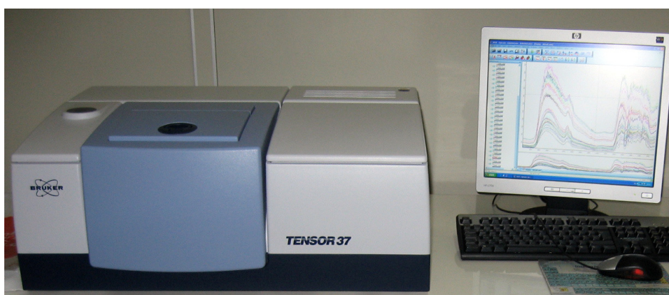
Figura 4.3 – Espectrofotômetro modelo Tensor 37 da marca Bruker.
