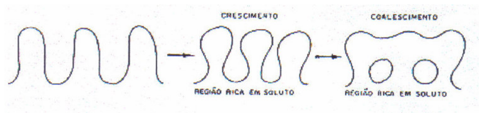
Figura 2.11- Esquema ilustrativo da formação das regiões ricas em soluto no fenômeno do coalescimento dos ramos dendríticos secundários [Chien & Kattamis, 1970; Flemings, 1974; Garcia, 2001].
