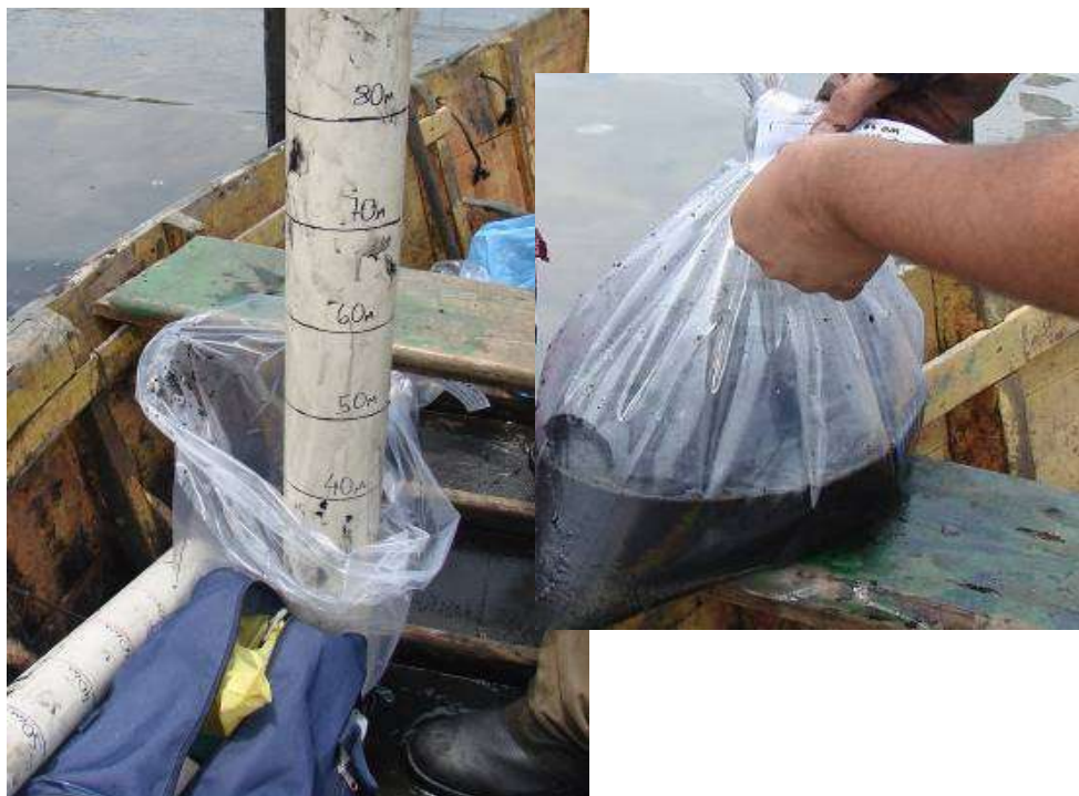
Figura 41 – Condicionamento do sedimento para posterior análise.
