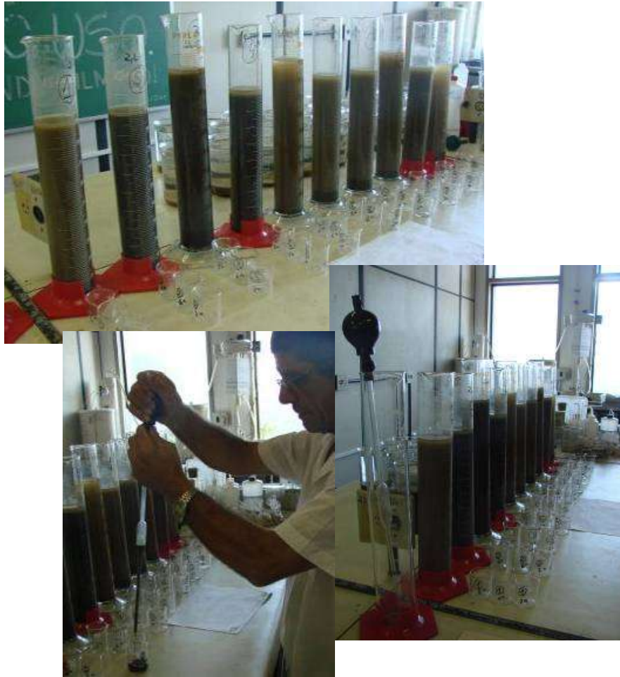
Figura 66 – Procedimento de decantação e pipetagem superficial.
