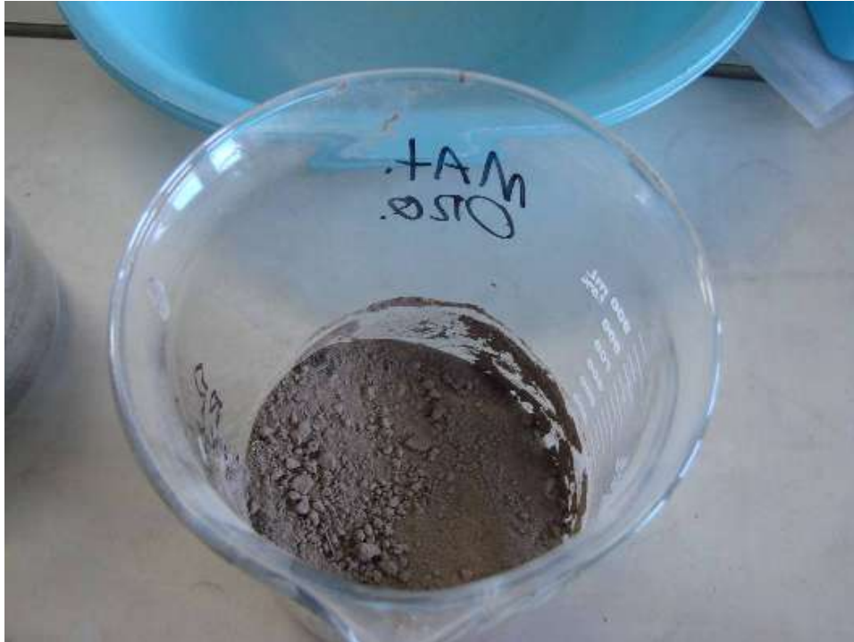
Figura 91 – Béquer contendo sedimentos após secagem na estufa, com coloração cinza.
