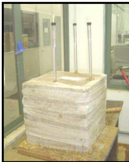
Figura 3.10- Tubos tensiométricos instalados no bloco
