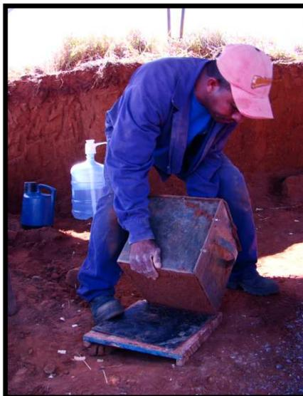
Figura 3. 5 – Amostra colocada sobre chapa metálica e chapa de madeira
