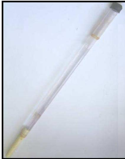
Figura 3.8 - Tubo tensiométrico
