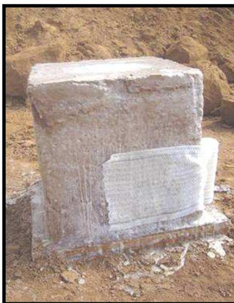
Figura 3.6- Bloco sendo envolvido em tecido poroso
