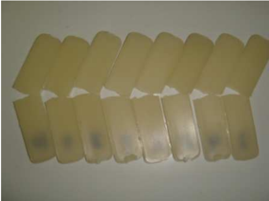
Fotografia 30 Ensaio de Impacto Nylon 6,12 Puro
