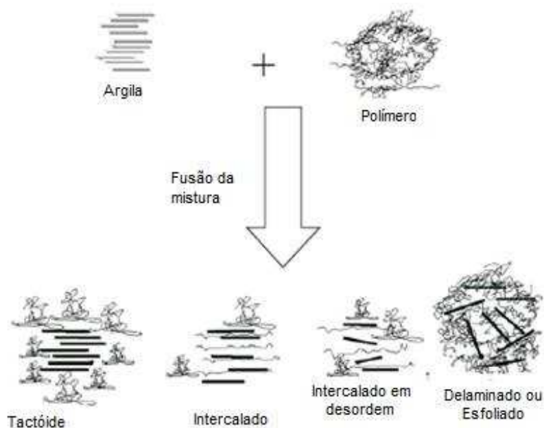
Esquema 4 Formação de nanocompósitos por argilas organofílicas (FORNES, PAUL, 2003)
