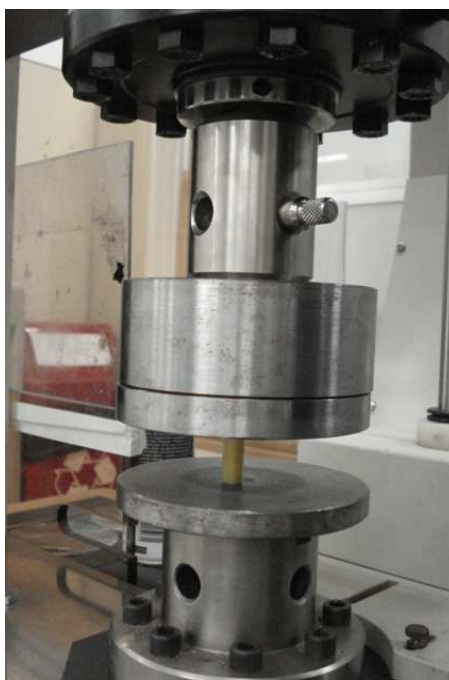
Fotografia 14 Ensaio de resistência à compressão
