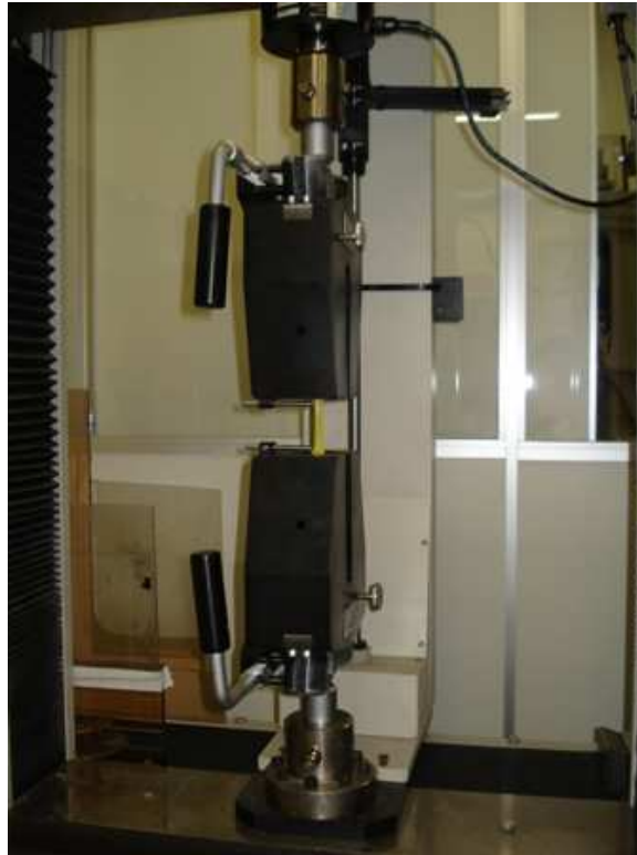
Fotografia 12 Ensaio de tração
