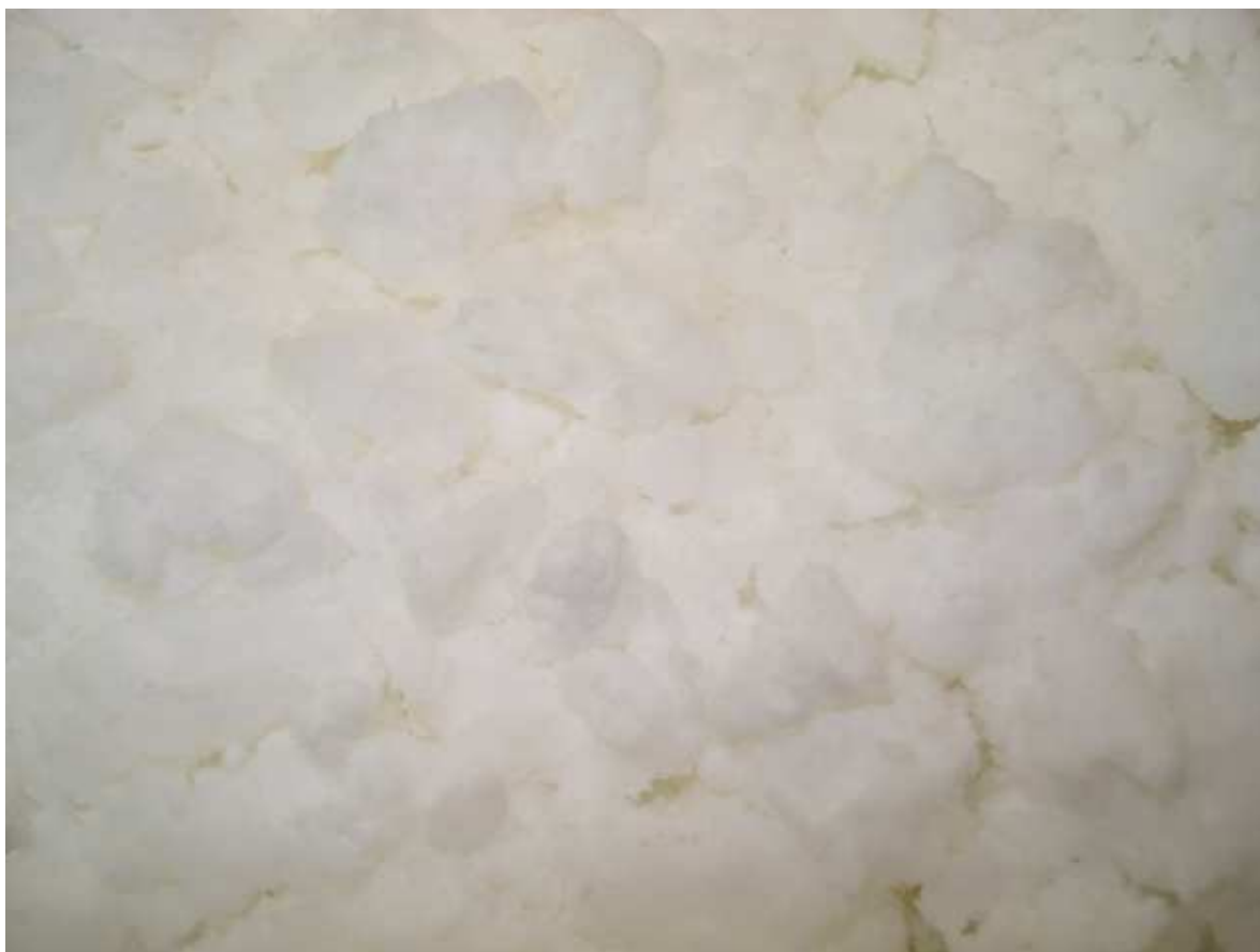
Fotografia 22 Gel de Pseudoboemita em escala de bancada
