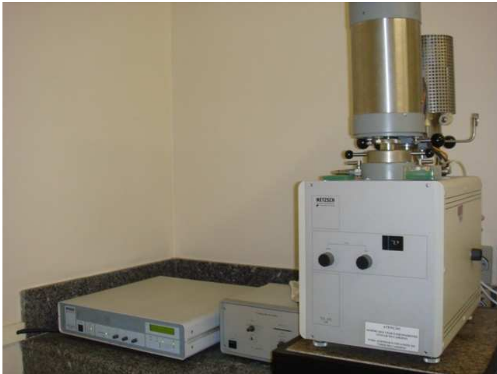
Fotografia 10 : Equipamento Netzsch-STA409C – Testes DSC e TG
