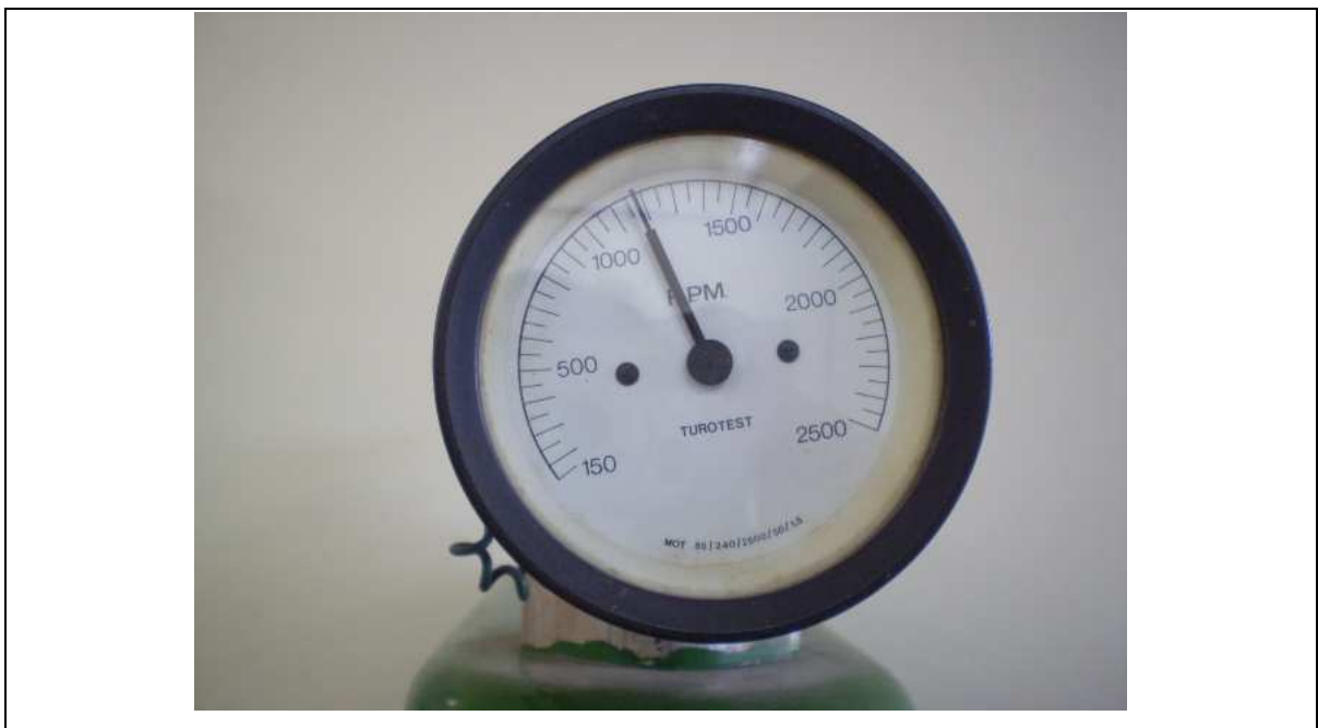
Figura 3.4: Rotações por minuto na célula de flotação (1200 rpm).
