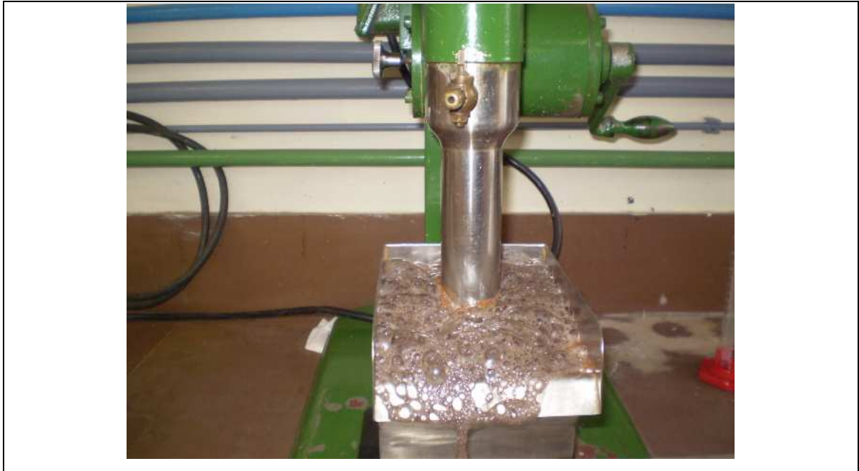
Figura 3.7: Início da flotação com agitação e introdução de ar ao sistema.
