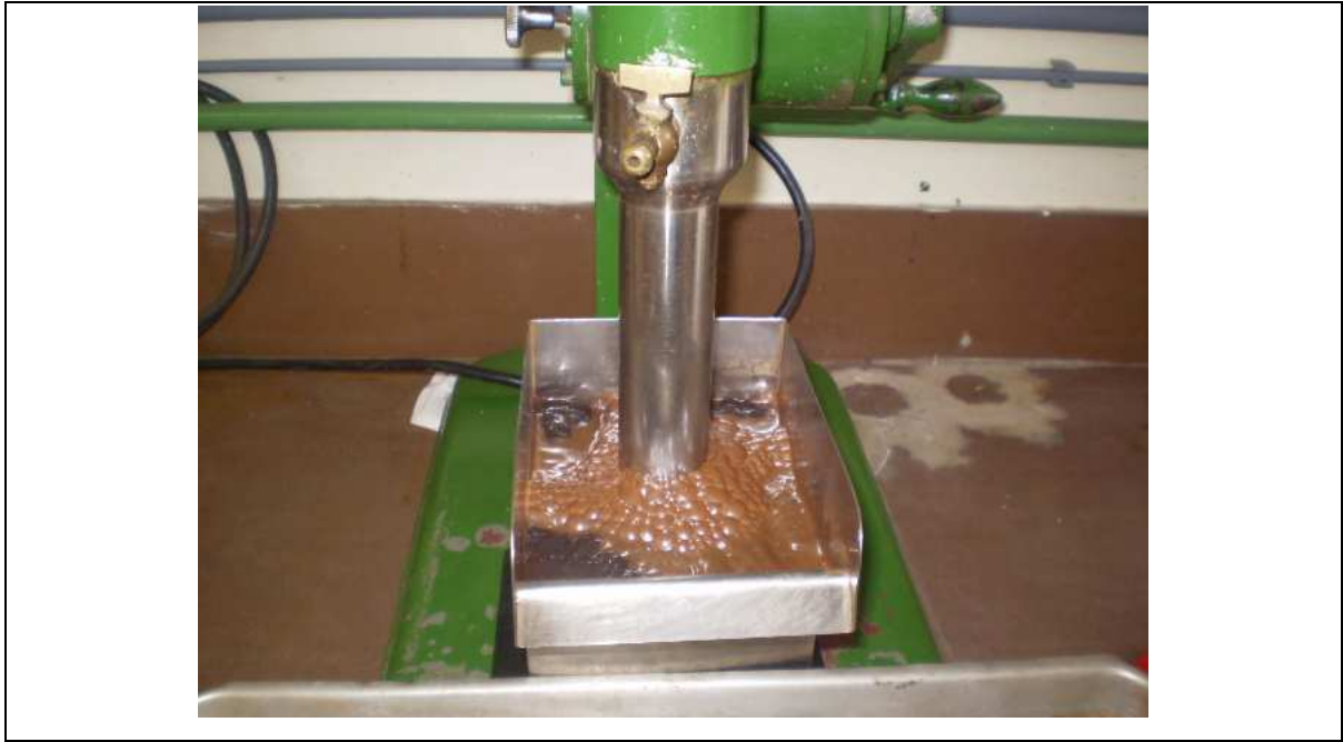
Figura 3.3: Agitação do minério de ferro por 1 minuto no processo de flotação.
