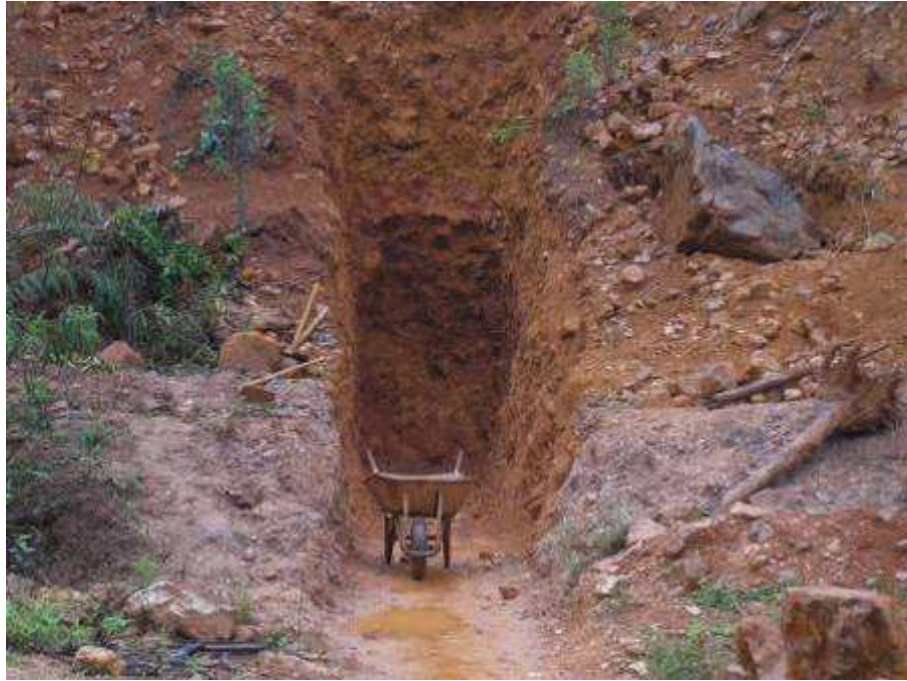
Foto 63 – Forma de exploração basicamente artesanal com a utilização de carrinhos de mão, enxadas, pás, enxadões, além de picaretas e muita força física dos trabalhadores desta região.
