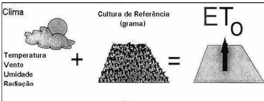
Figura 2.22 - Principais fatores ambientais envolvidos para determinação do modelo utilizado para cálculo da Evapotranspiração Potencial.
