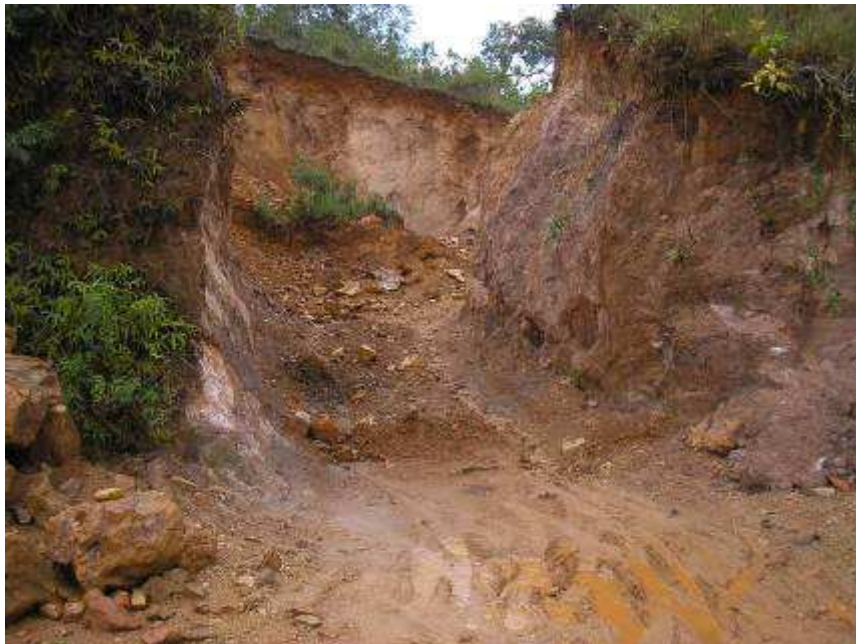
Foto 62 – Local de exploração do material denominado Pedra Sabão, facilmente encontrado nos horizontes subjacentes aos perfis B incipiente e B latossólico comuns nesta região.
