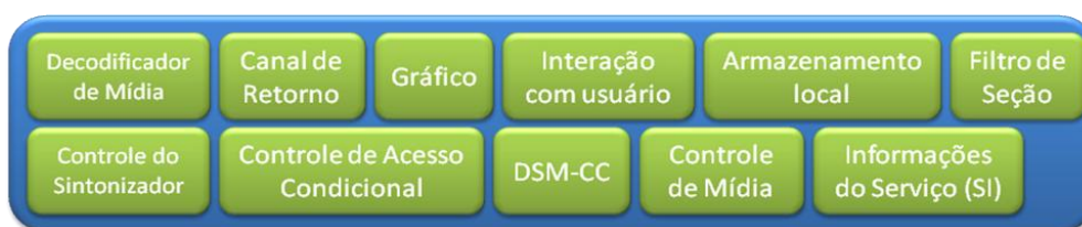
Figura 17 – Camada de Adaptação do OpenMHP
