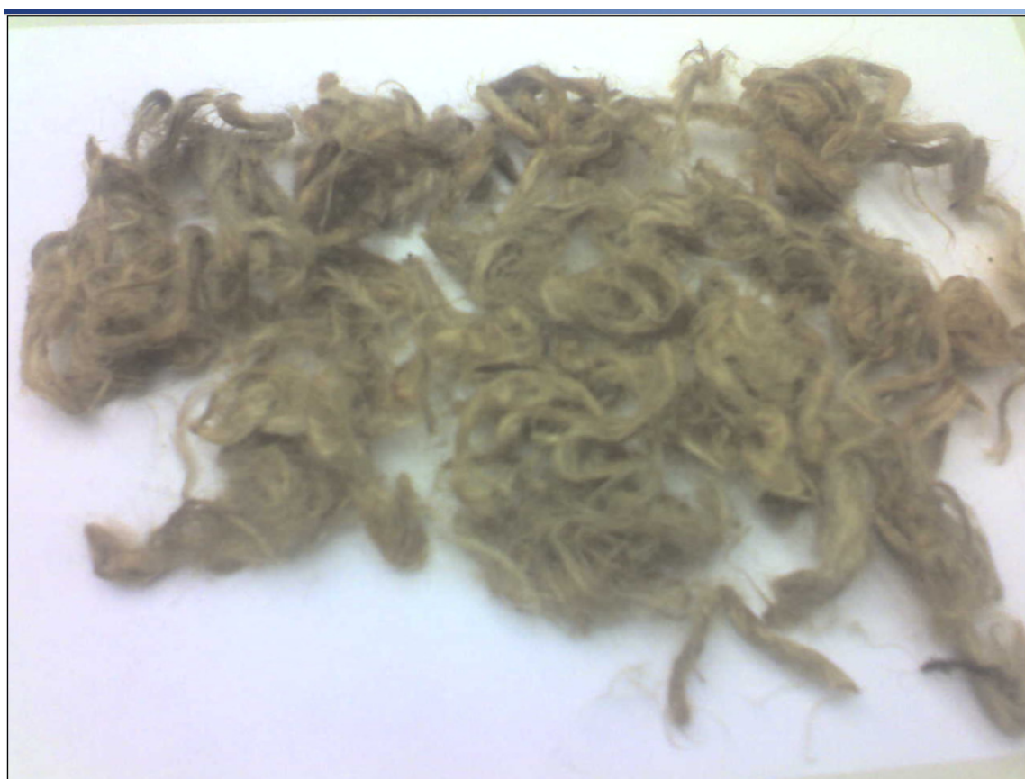
Fotografia 8: Fibra de juta depois do tratamento (mercerização)
