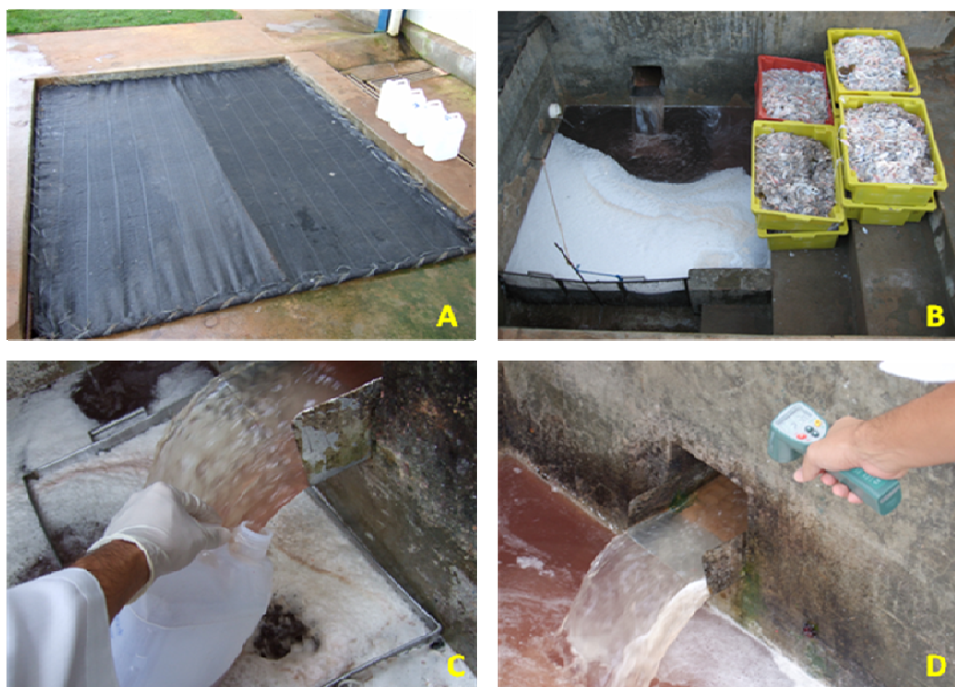
FOTO 1. Local e condição das coletas das amostras do efluente. A – tela de proteção sobre a calha de saída do resíduo da indústria de processamento de tilápia. B – detalhe do gradeamento na calha de saída do efluente para a separação dos sólidos grosseiros. C – procedimento de coleta do efluente diretamente na calha de saída. D – determinação da temperatura do efluente pelo termômetro de luz infravermelho.
