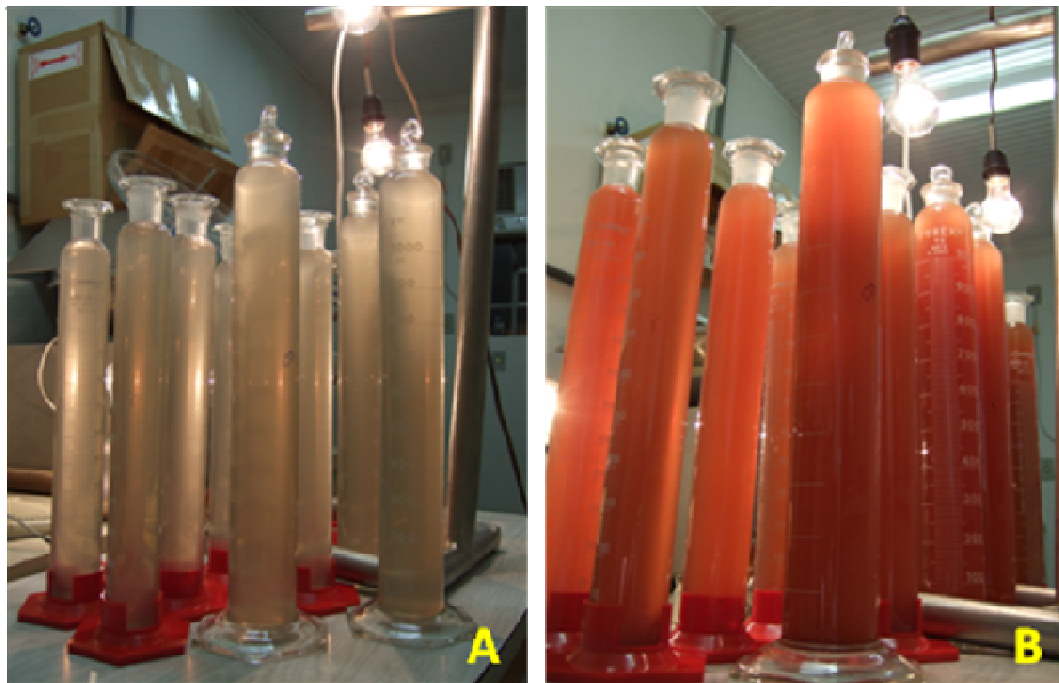
FOTO 4. Provetas de vidro utilizadas para a determinação das curvas de crescimento contendo o efluente da indústria de processamento de tilápias inoculado com o micro-organismo Rubrivivax gelatinosus . A – Antes do cultivo. B – segundo dia do cultivo.
