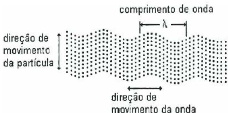
Figura 2.10: Representação esquemática de onda ultrassônica transversal [CARVALHO, 2005].
