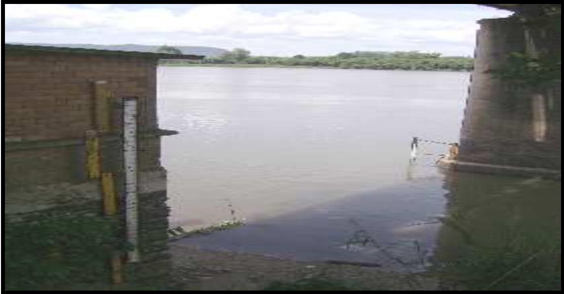
Figura 3 - Posto fluviométrico sob a Ponte Machado da Costa em Porto União – SC (2009)
