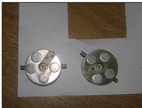
**Figura 11** – Amostras coladas no porta-amostra. Preparadas para polimento.
