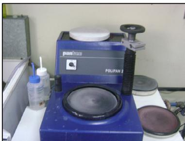
**Figura 10** – Polipan 2. Equipamento utilizado para polimento mecânico.
