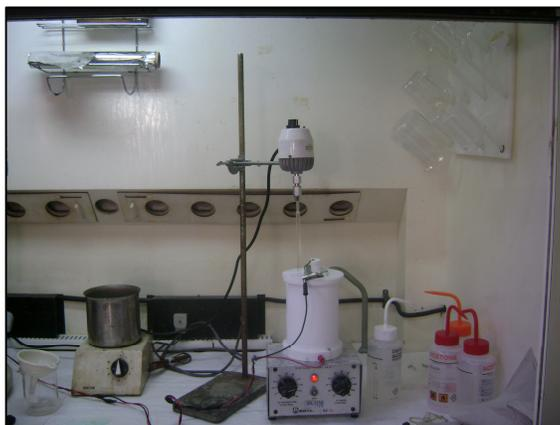
**Figura 12** – Montagem disponível no IF-UFRGS utilizada para anodizações e eletropolimento neste trabalho. Módulo Stir Kool Model SK 12 da Aldrich.
