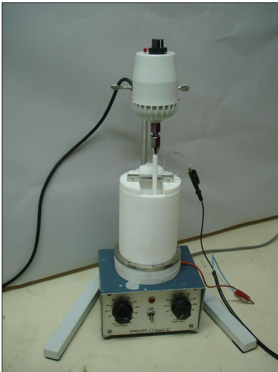
**Figura 65** – Fotografia do arranjo experimental para anodização construído no CDTN.
