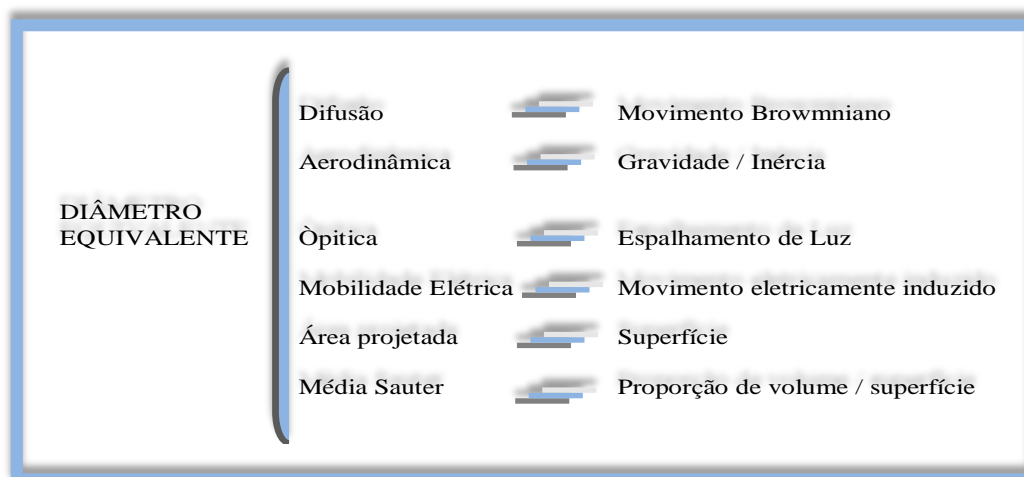
FIGURA 2.4: Diâmetro equivalente em função das propriedades e do comportamento das partículas (WILLKE e BARON, 1993).
