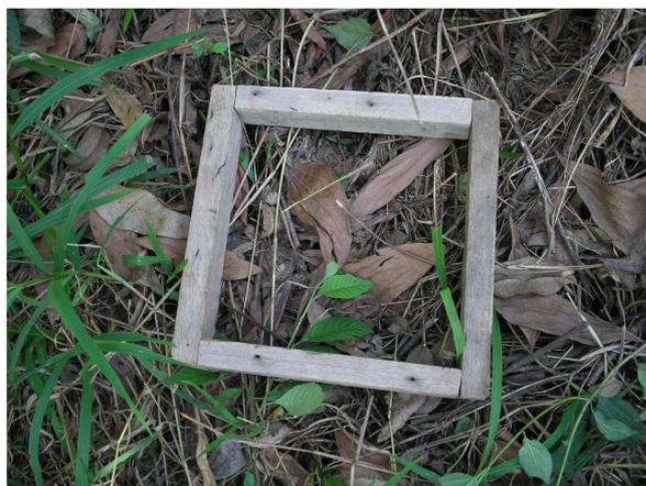
**Figura 6.** Visão superior do coletor de amostras para análise da fauna do solo.
