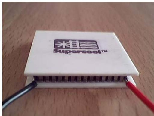
**Figura 9:** Foto de uma pastilha com efeito *Peltier*, semelhante a utilizada nos ensaios. Foto extraída do site: [www.jaderfranca.com/blog/wp-content/uploads/2008/08/peltier4.jpg](http://www.jaderfranca.com/blog/wp-content/uploads/2008/08/peltier4.jpg).
