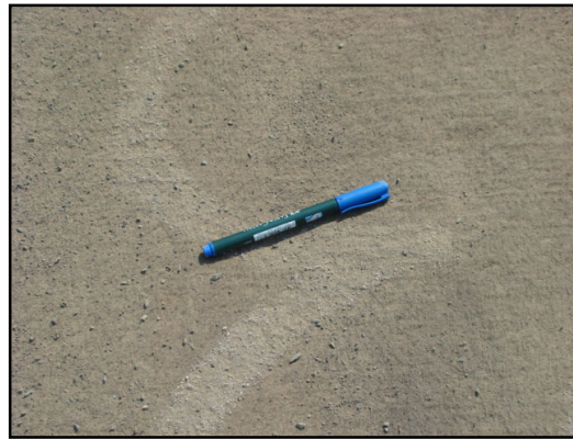
Figura 159. Danos visuais: GM de PVC de 1,0 mm com GT PET 600 g/m 2 e brita 1.
