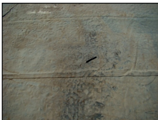
Figura 157. Danos visuais: GM de PVC de 2,0 mm sem proteção e brita 3.
