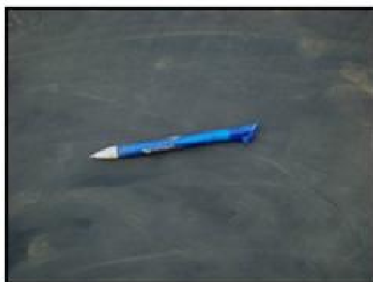
Figura 106. Danos visuais: GM de PEAD de 1,5 mm com GT PET 1200 g/m 2 e brita 3.
