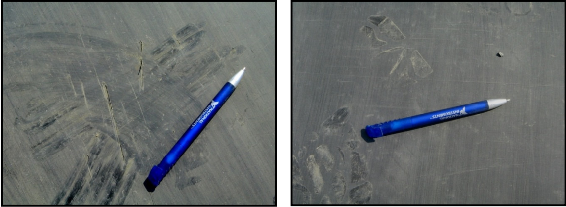
Figura 110. Danos visuais: GM de PEAD de 1,5 mm com GT PET 300 g/m 2 e brita 1.
