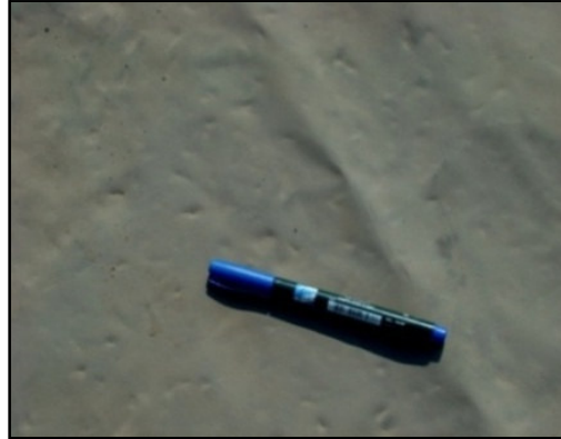
Figura 158. Danos visuais: GM de PVC de 1,0 mm sem proteção e brita 1.
