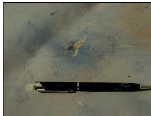
Figura 157. Danos visuais: GM de PVC de 2,0 mm sem proteção e brita 3.
