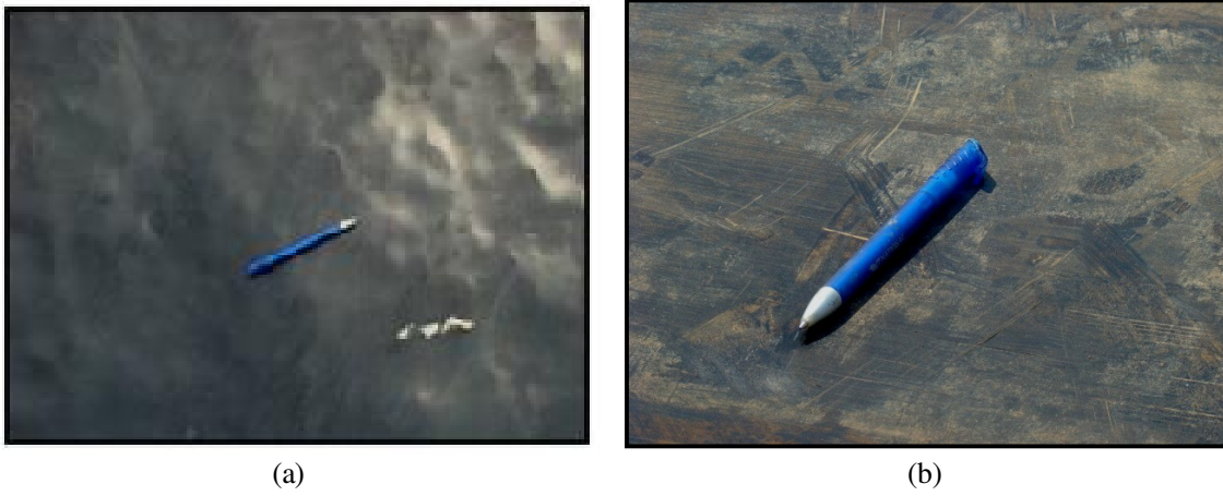
Figura 107. Danos visuais: GM de PEAD de 1,5 mm com camadas naturais e brita 3: (a) areia; (b) solo.
