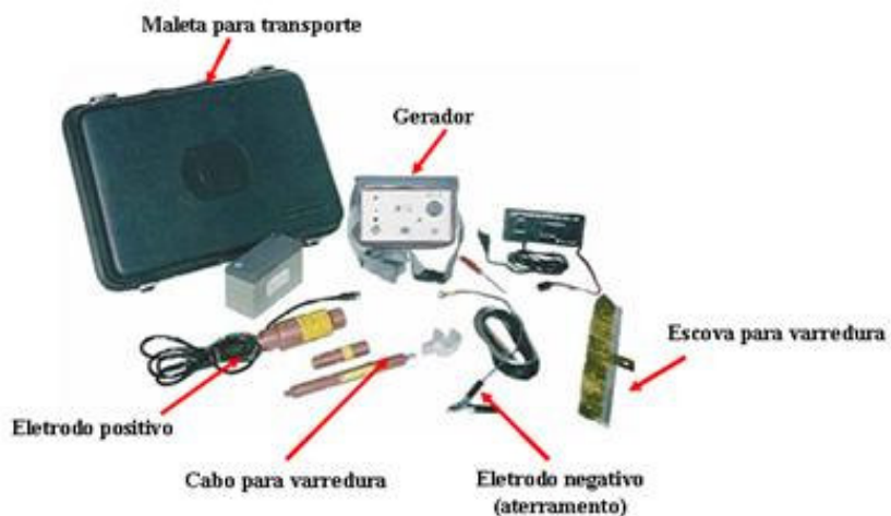
Figura 45. Detalhes do equipamento do Spark Test .
