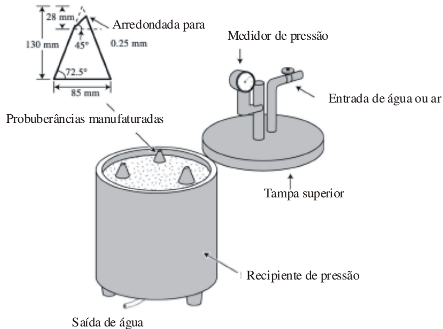
Figura 25. Ensaio de punção hidrostática com cones truncados.
