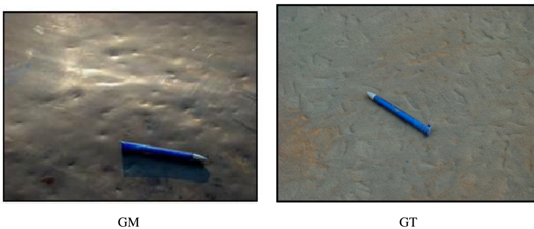
Figura 105. Danos visuais: GM de PEAD de 1,5 mm com GT PP 600 g/m 2 e brita 3.
