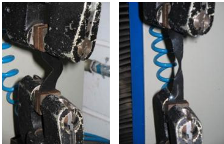
Figura 47. Ilustração do ensaio de rasgo em geomembrana de PEAD.
