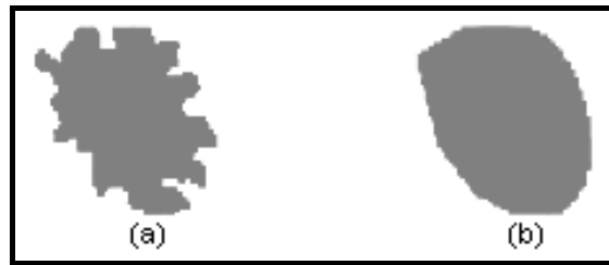
Figura 17: Exemplo de perímetro convexo. (a) Objeto com picos e defeitos. (b) Objeto com superfície convexa. Fonte: (FONSECA, 2001).
